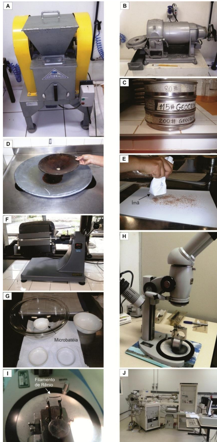
Figura 9 - Equipamentos utilizados para concentração de zircões e estudo geocronológico. (A) Britador, (B) moinho a disco, (C) Conjunto de peneiras nas frações 80 #, 115# e 200 #, (D) conjunto de bateias, (E) Separação de minerais magnéticos com auxílio de ímã de mão, (F) Separador eletromagnético Isodynamic Frantz , (G) Conjunto de microbateias, (H) Lupa binocular, (I) Filamento de Rênio, (J) Espectrômetro de massa (TIMS) modelo Finnigan MAT 262.
