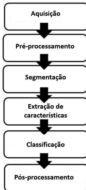
Figura 1. Fluxo grama etapas do processamento de imagem.
