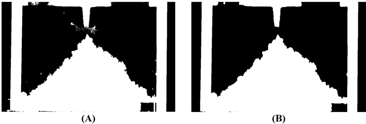
Figura 13. Imagem com comando imfill (A); Imagem com o comando imopen (B).
