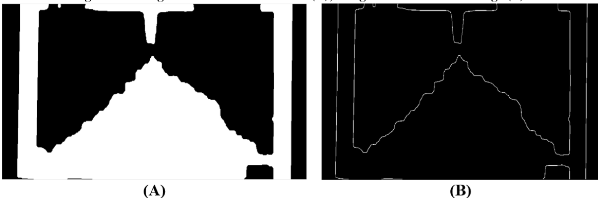
Figura 14. Imagem com comando imclose (A); Imagem com o comando edge (B).
