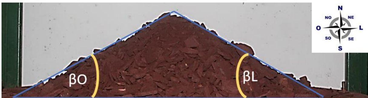
Figura 9. Esquemas das medições dos ângulos para a direção oeste e leste da pilha.
