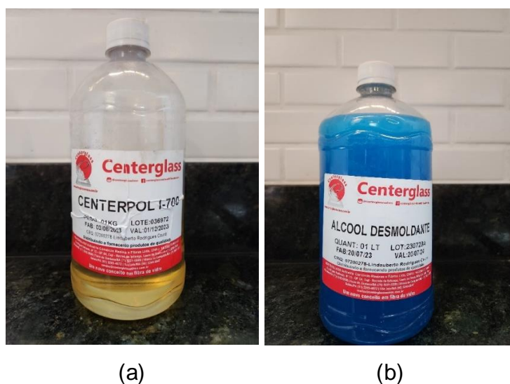
Figura 8 - Materiais: a) Resina Poliéster isofitálica; b) desmoldante; c) acelerador de cobalto e d) iniciador peróxido de etil-meti cetona (MEK-P).
