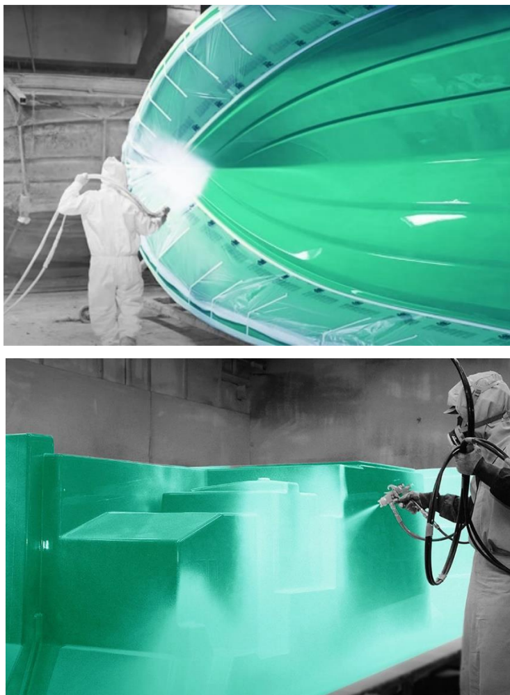
Figura 6: Construção de embarcações que tem o Gelcoat como elemento principal, que é produzida a base de resina de poliéster isoftálica insaturada.
