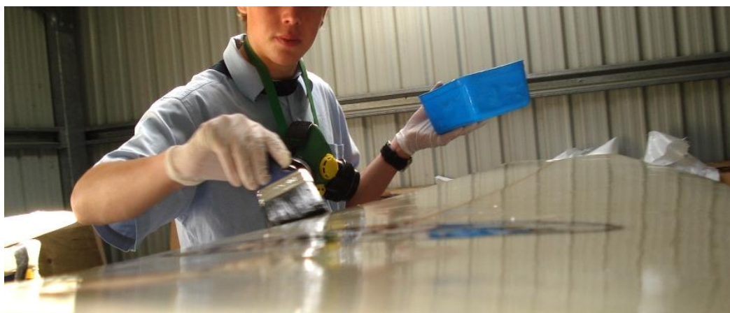
Figura 4: Aplicação de resina isoftálica.
