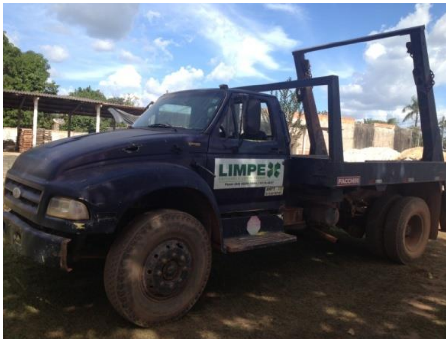
Figura 27 - Caminhão-guincho coletor de material de construção civil. Fonte: LIMPEX, 2013
