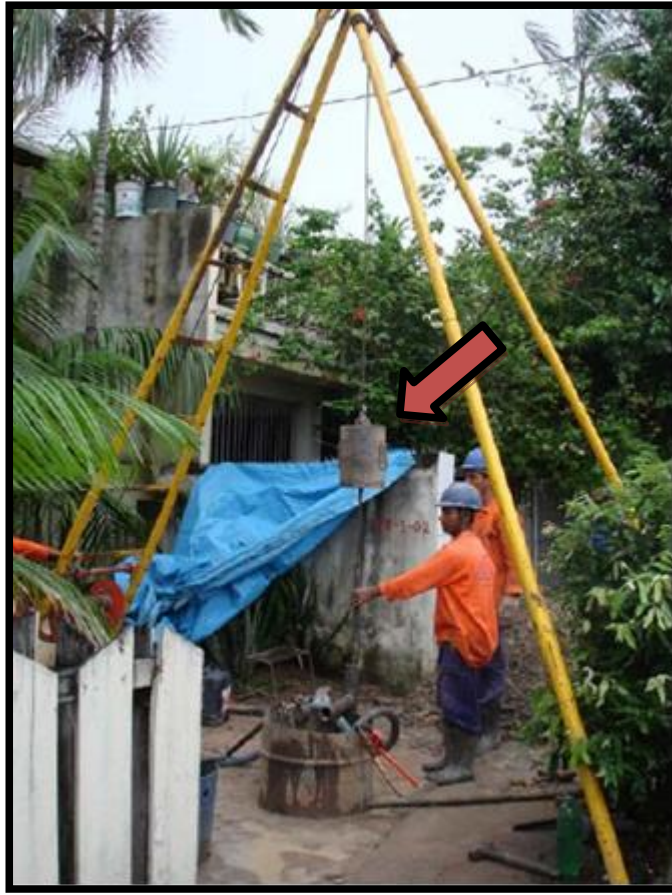
FIGURA 11 – Furo SPT-02 que foi acompanhado na Rua Osvaldo de Caldas Brito esquina com a Travessa Breves. Seta vermelha indicando o martelo utilizado em queda livre para penetração do amostrador.
