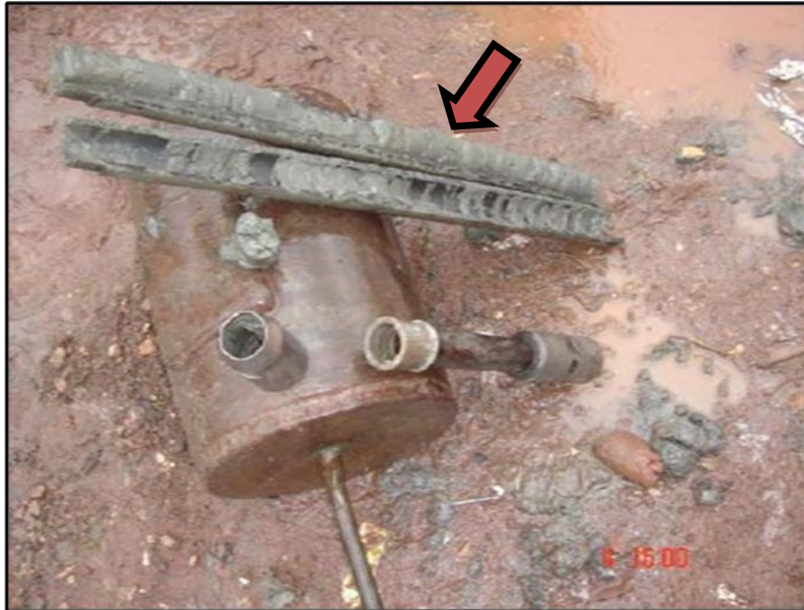
FIGURA 10 – Foto do amostrador de Raymond no furo SPT-07 que foi utilizado na Rua Caripunas, entre Travessa Breves e Avenida Bernardo Saião.
