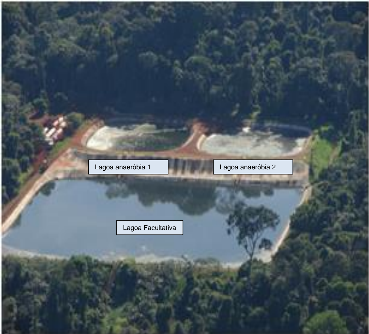
Figura 34: Estação de Tratamento de Esgoto (Lagoas de Estabilização) do Núcleo Urbano de Carajás (2008).
