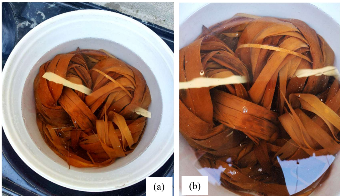
Figura 19 - Envira cheirosa imersa em água: Fibras imersas (a); destaque das fibras (b)
