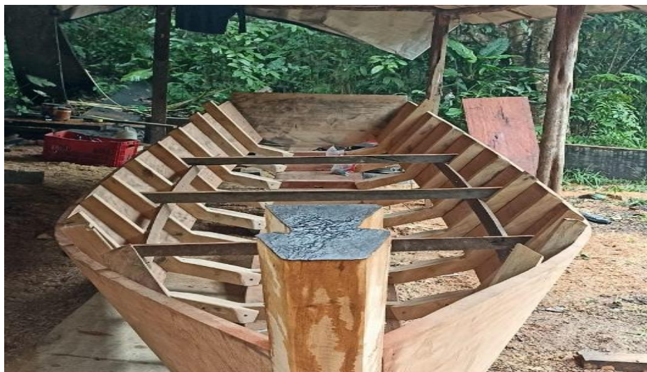
Figura 13. Conjunto de cavernas formando o arcabouço de uma canoa rabeta
