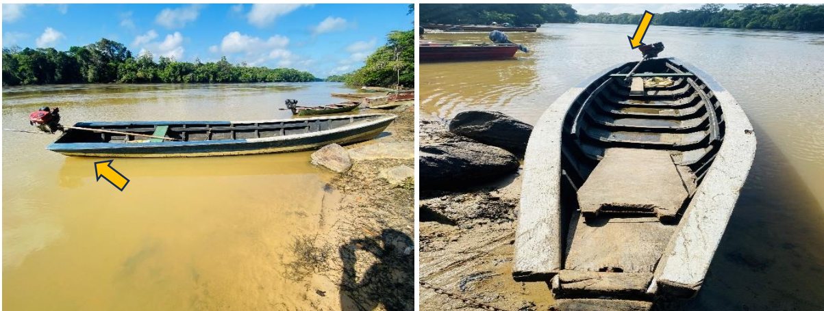
Figura 9. Canoa rabeta com deformação, em virtude do uso de tábuas de espécies diferentes no processo de encostamento.
