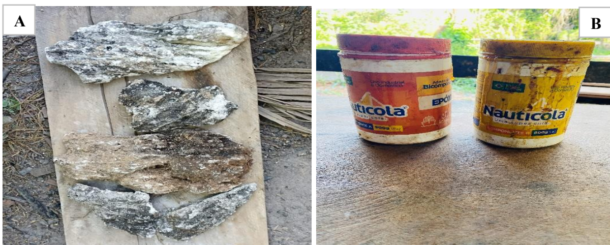
Figura 20. (A) produto natural chamado de breu (B) nauticola epóxi
