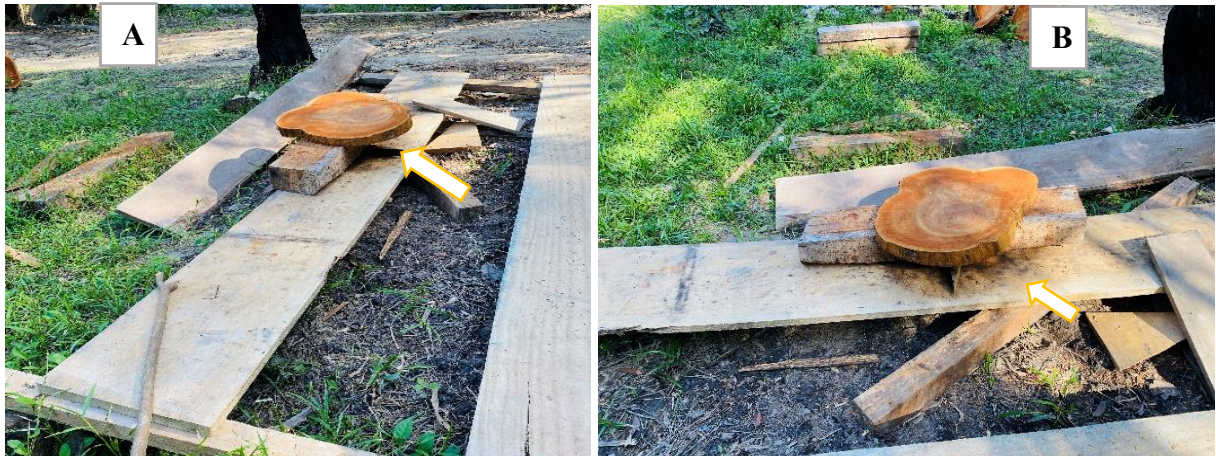
Figura 27. Técnica aplicada na tábua principal para fazer a curvatura (A, B).
