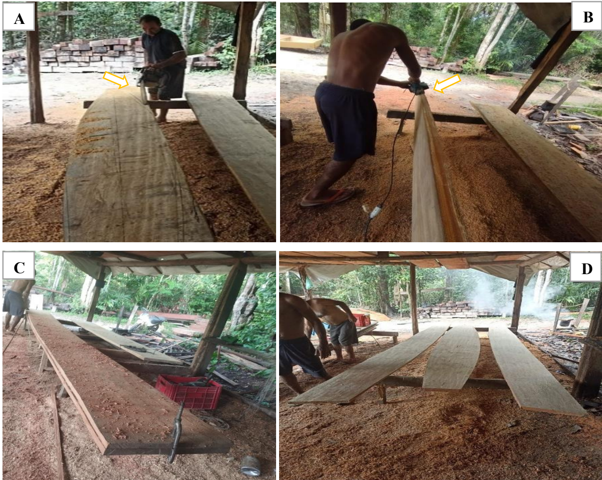
Figura 28. Processo de modelagem das tábuas durante a confecção de uma canoa de pesca. (A) risco e corte na tábua principal com graus de inclinação; (B) modelagem da lateral da tábua principal com a plaina; (C) cortes das tábuas do encostamento; (D) tábuas prontas para formação da canoa.
