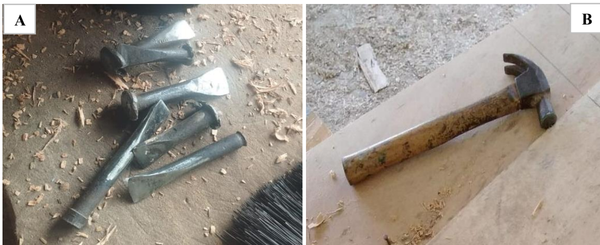
Figura 19. (A) Ferros chamados de batedores de estopa; (B) martelo.
