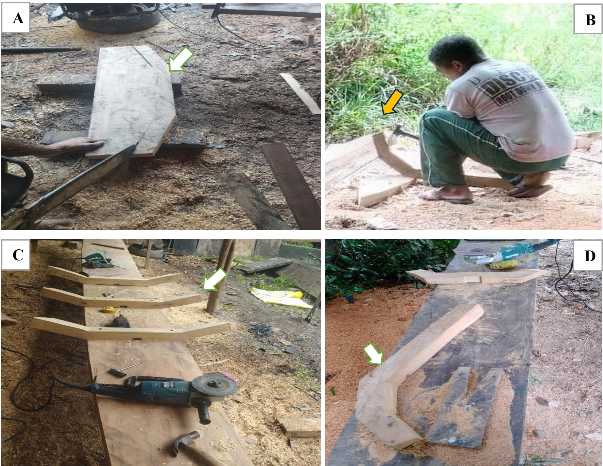
Figura 13. Conjunto de cavernas formando o arcabouço de uma canoa rabeta
