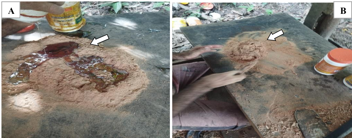
Figura 21. (A) e (B) Preparação da cola náutica com o pó da madeira.
