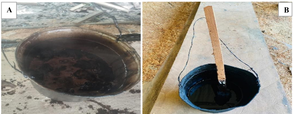
Figura 22. (A) breu no processo de preparação, sendo derretido no fogo; (B) breu derretido e preparado para ser passado na canoa.
