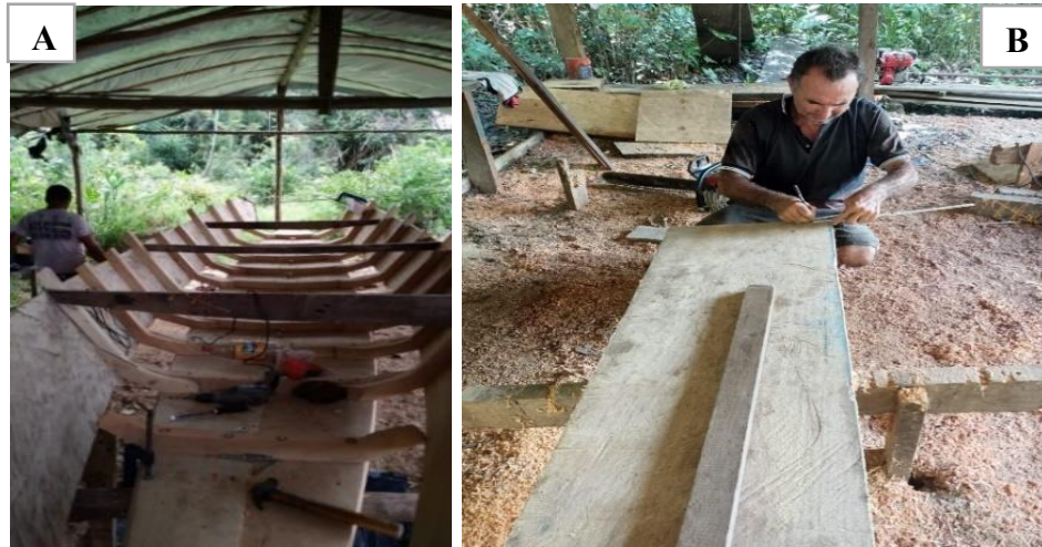
Figura 7. (A) armação de uma canoa rabeta construída pelo mestre Lacioesse, (B) mestre Ozinho fazendo medidas na tábua do encostamento.
