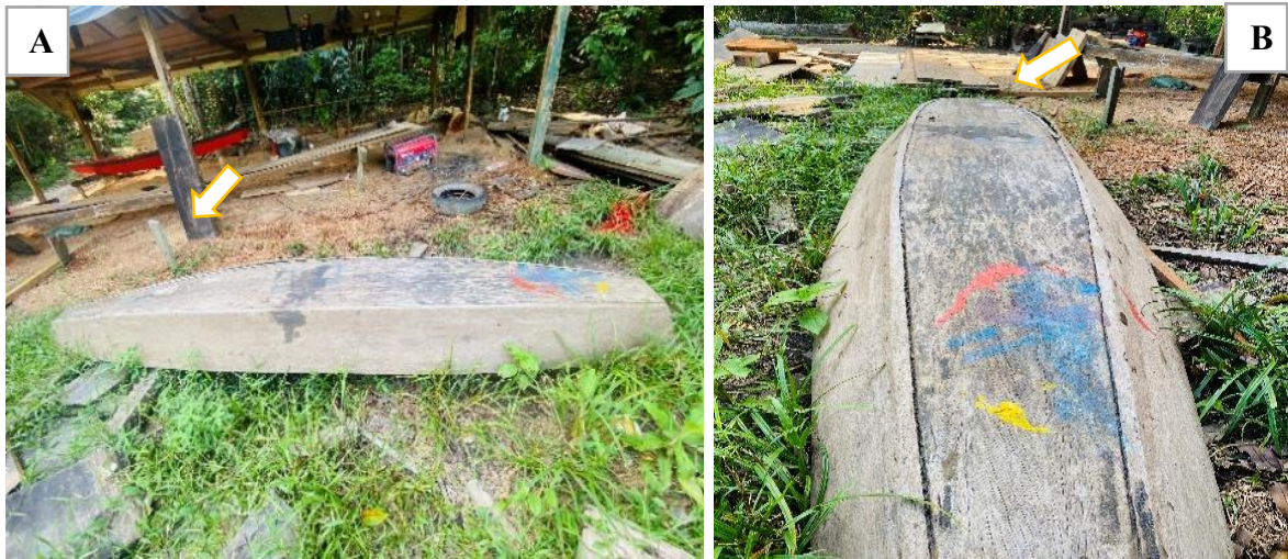
Figura 30. Curvatura na peça de fundo da canoa de pesca.
