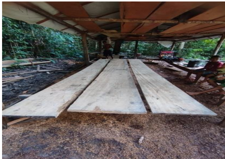
Figura 26. Seleção das tábuas de piquiá para a confecção de uma canoa de pesca.
