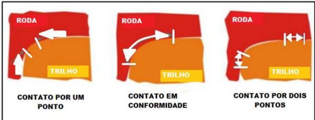
Figura 6 – Região do boleto onde surgem as tensões de contato.
