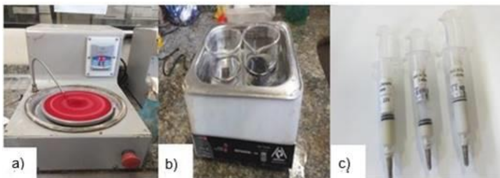
Figura 22 – a) Politriz, b) Cuba ultrassônica e c) Pastas de diamante.
