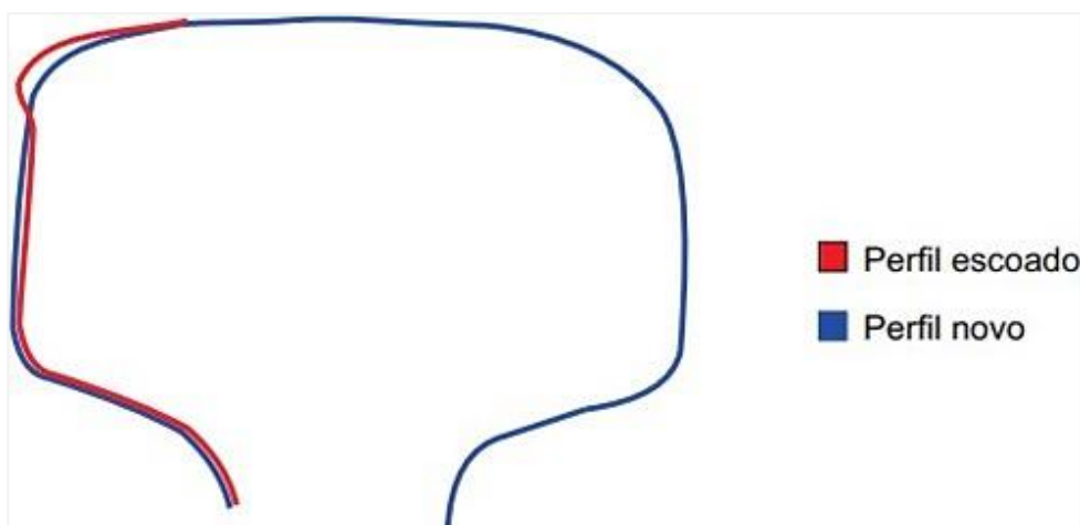
Figura 30 – Escoamento do canto externo do trilho.
