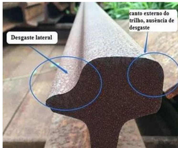
Figura 7 – Presença do desgaste lateral no canto da bitola de trilho ferroviário.
