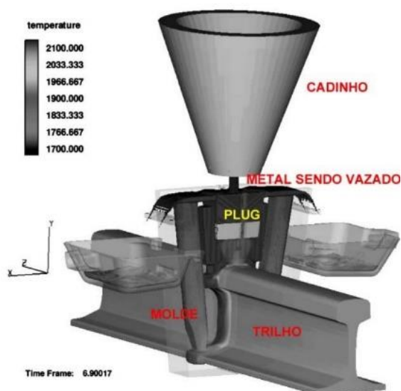
Figura 14 – Representação esquemática de processo de soldagem aluminotérmica de trilho.
