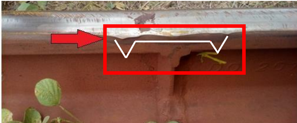
Figura 37 – Perfil longitudinal de dureza Rockwell C na região do escoamento, que abrange a solda aluminotérmica.
