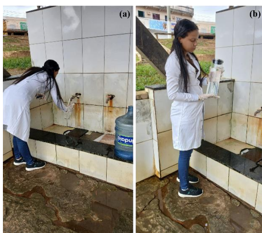
(a) Coleta da amostra e (b) Acondicionamento da amostra no frasco de vidro;
