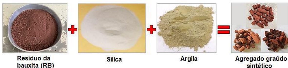
Figura 5 – Composição do agregado graúdo sintético
