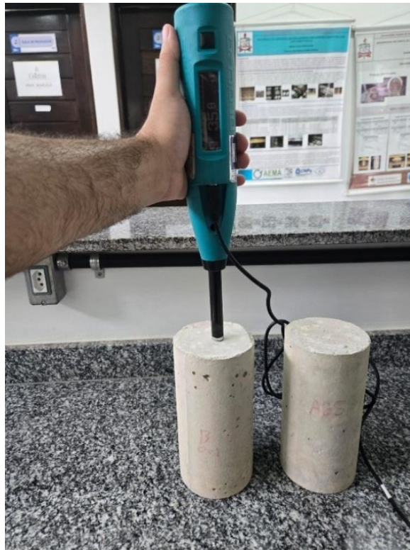
Figura 14 – Ensaio com esclerômetro (martelo Schmidt)
