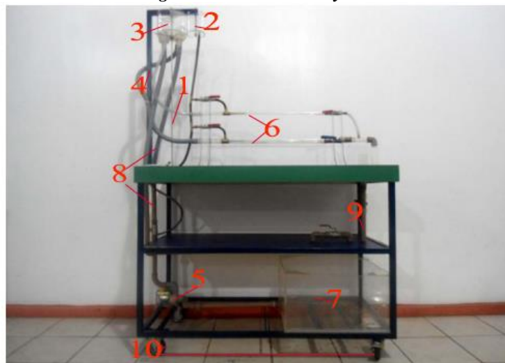
Figura. 3 Bancada de Reynolds
