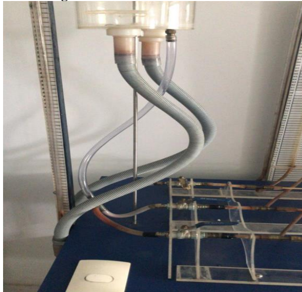
Figura. 16 Haste móvel de Poiseuille
