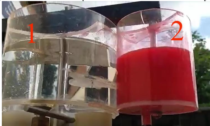
Figura. 7 Reservatórios de adição de fluido e corante da bancada de Reynolds
