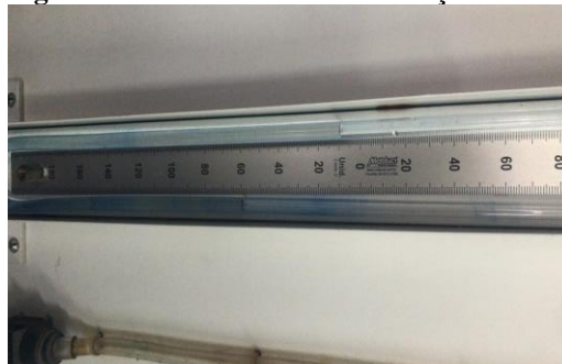
Figura. 30 Manômetro em U medição 52 mm
