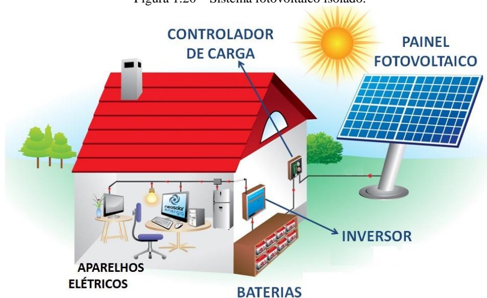
Figura 1.20 – Sistema fotovoltaico isolado.
