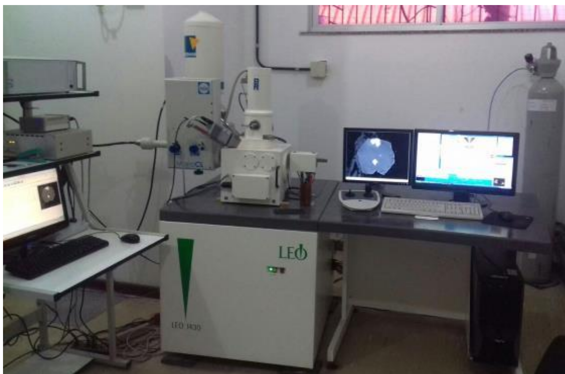
Figura 3 – Aspecto geral do Microscópio Eletrônico de Varredura com Espectroscopia por Dispersão de Energia de Raios X (MEV-EDS), modelo Zeiss Leo 1430 , do Programa de Pós-Graduação em Geologia e Geoquímica (PPGG) da Universidade Federal do Pará.
