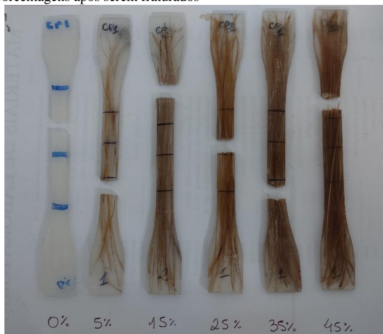
Figura 27: Aspecto macroscópico de corpos de prova de tração de diferentes porcentagens após serem fraturados
