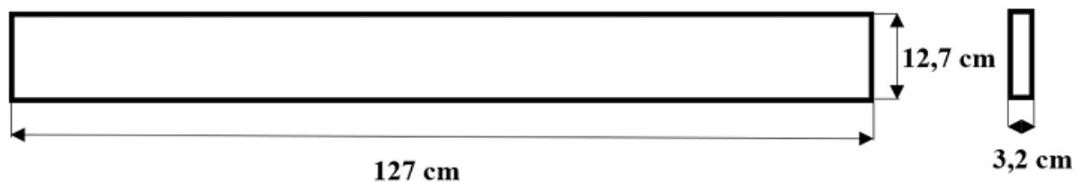
Figura 18: Dimensões em milímetros de corpos de prova estipulados pela norma ASTM D790 para flexão
