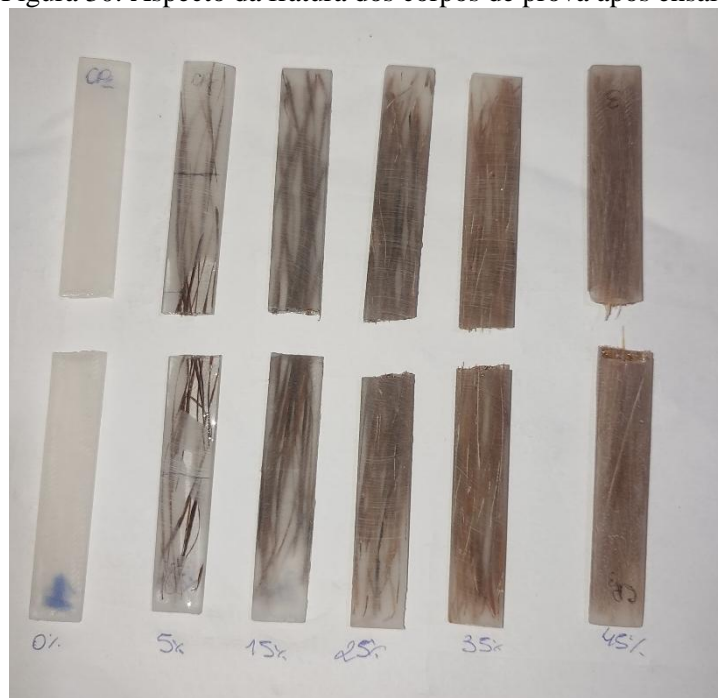
Figura 30: Aspecto da fratura dos corpos de prova após ensaio de flexão
