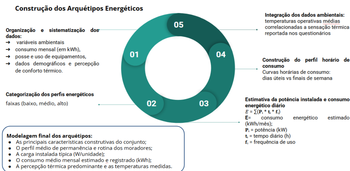
Figura 13: Metodologia para construção dos arquétipos energéticos
