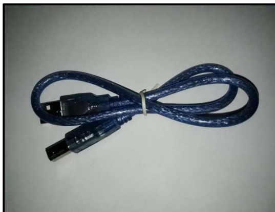
Figura 4.6 – Cabo USB para alimentação da placa.
