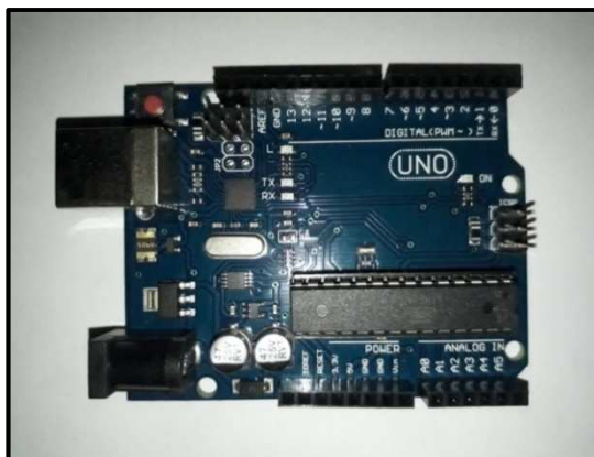
Figura 4.4 – Placa Arduino UNO.
