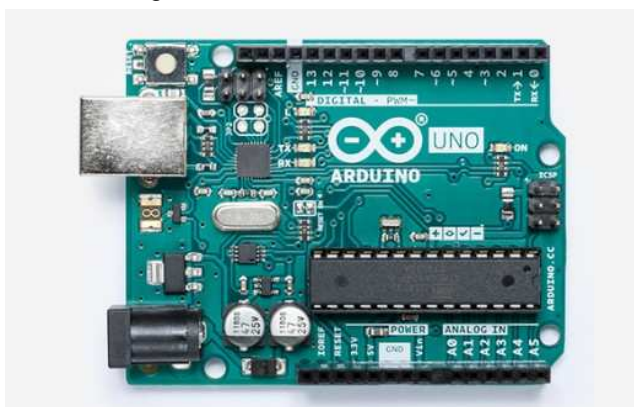
Figura 1.1 – Placa Arduino UNO.
