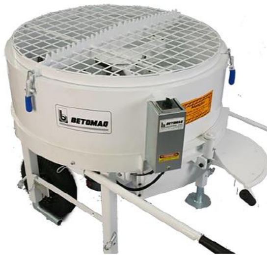
Figura 23 – Exemplo de misturador biplanetário.
