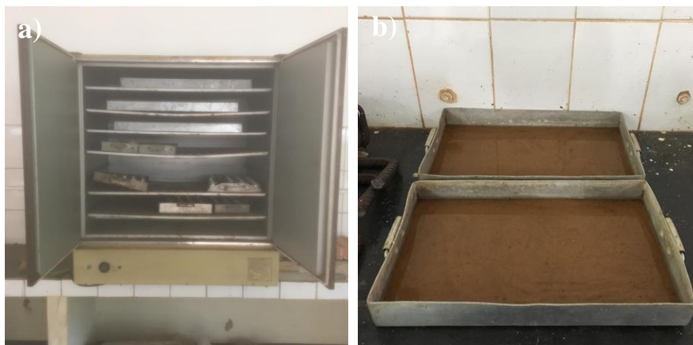
Figura 31 – Preparação das amostras do ensaio: a) AMN em estufa e b) AMN submerso em água.
