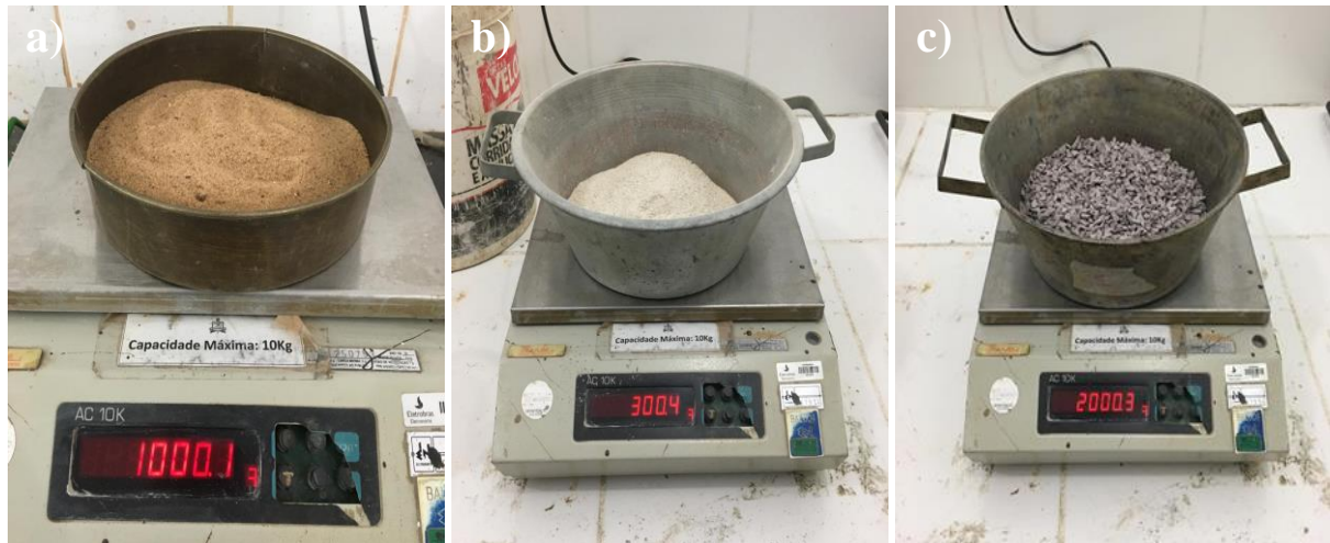
Figura 30 – Massa das amostras do ensaio de granulometria: a) agregado miúdo natural; b) agregado miúdo artificial; e c) agregado graúdo.
