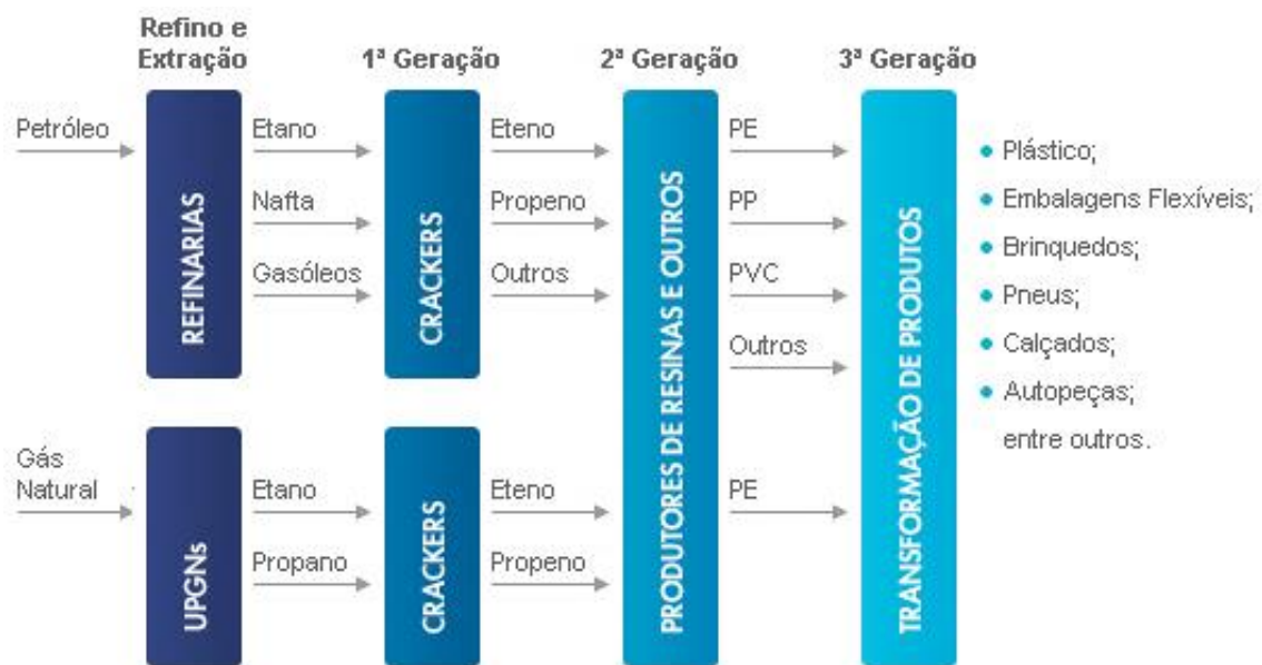
Figura 2 – Esquema da refinação do petróleo.
