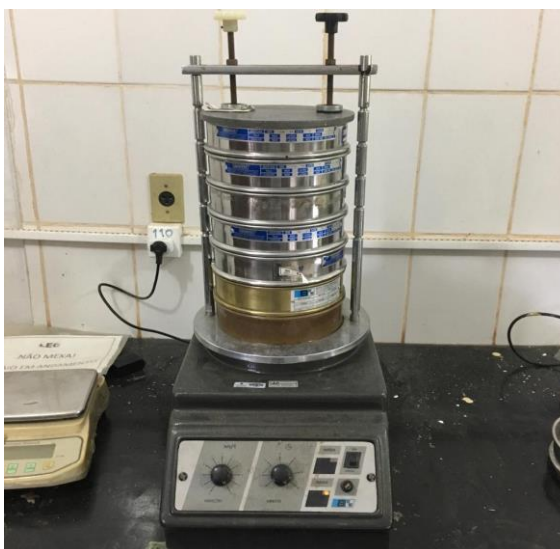
Figura 29 – Agitador mecânico de peneiras.
