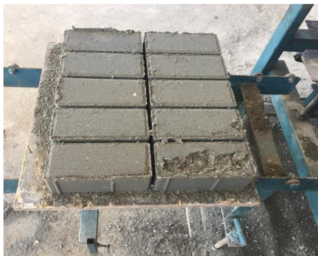
Figura 53 – Imperfeição do paver devido ao excesso de água, utilizando a vibroprensa pneumática disponível.
