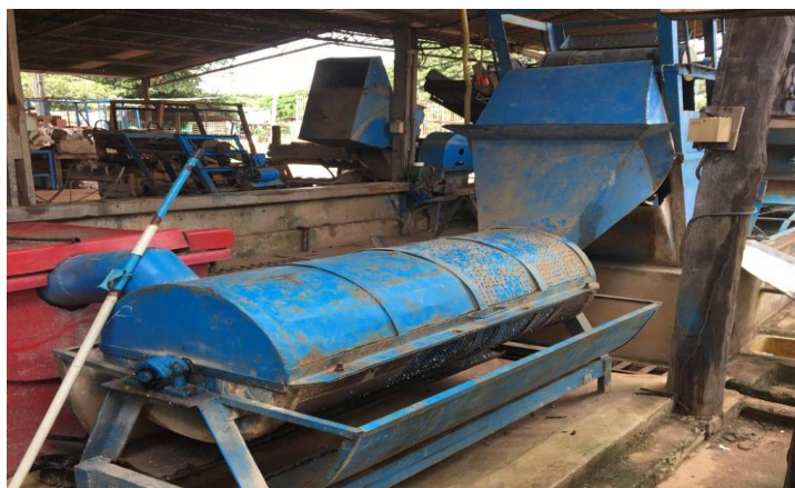
Figura 27 – Equipamento de lavagem do material e separador do RPP.
