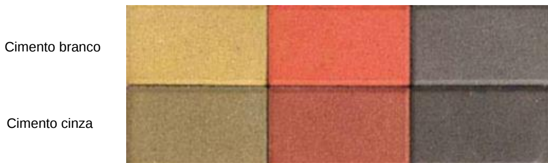
Figura 8: Influência do cimento na cor final.
