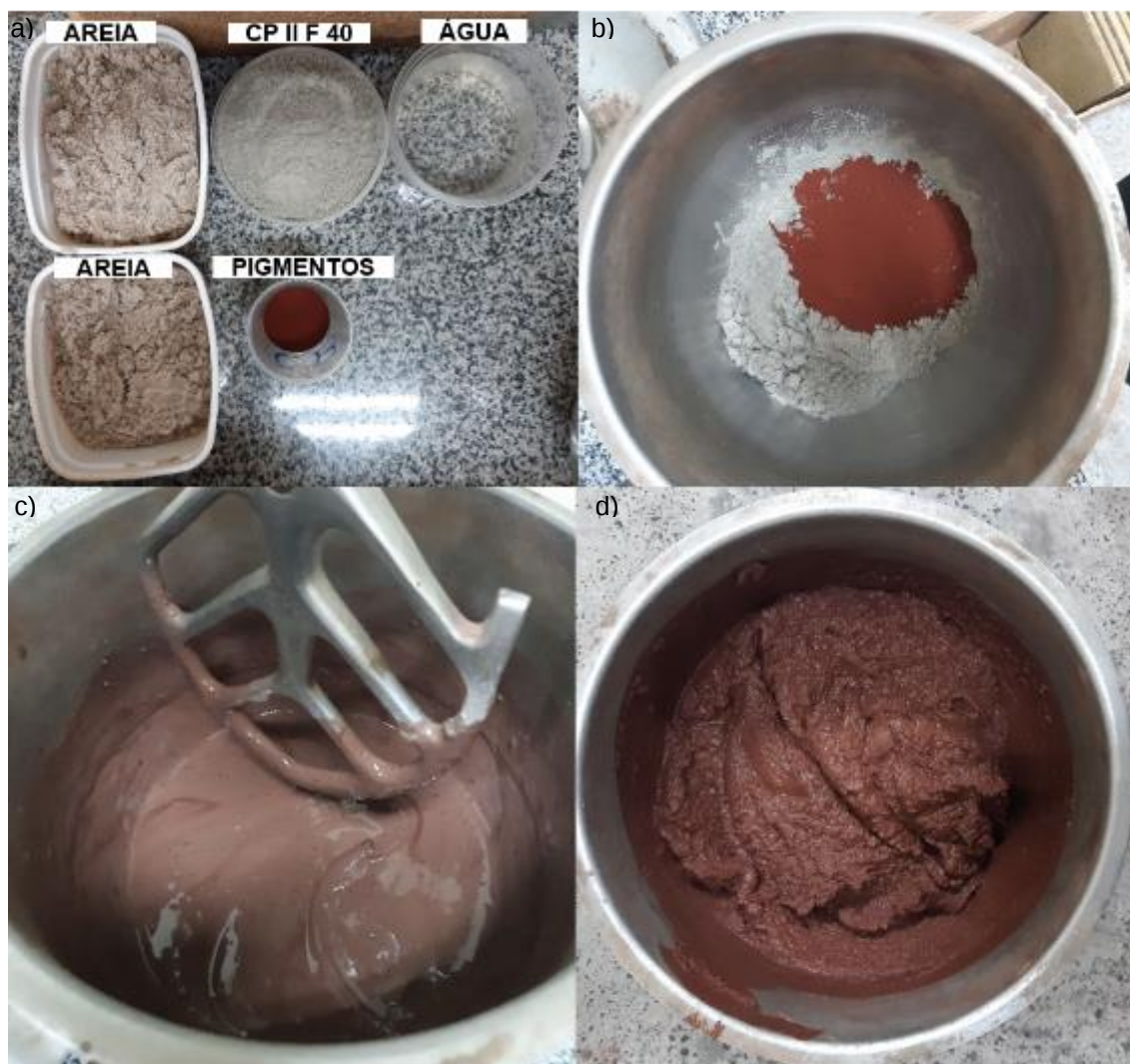
Figura 29: a) Materiais utilizados; b) Mistura do cimento com os pigmentos; c) Após adição de água; d) Após adição de areia.
