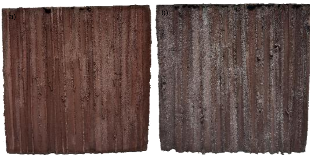
Figura 48: a) LC 3 com pigmentos vermelho e preto, textura de bambu; b) Cimento CPIIF40 com pigmentos vermelho e preto, textura de bambu.
