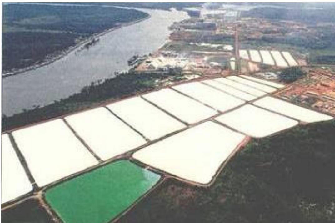
Figura 9: Deposição dos resíduos caulíníficos em lagoas de sedimentação.
