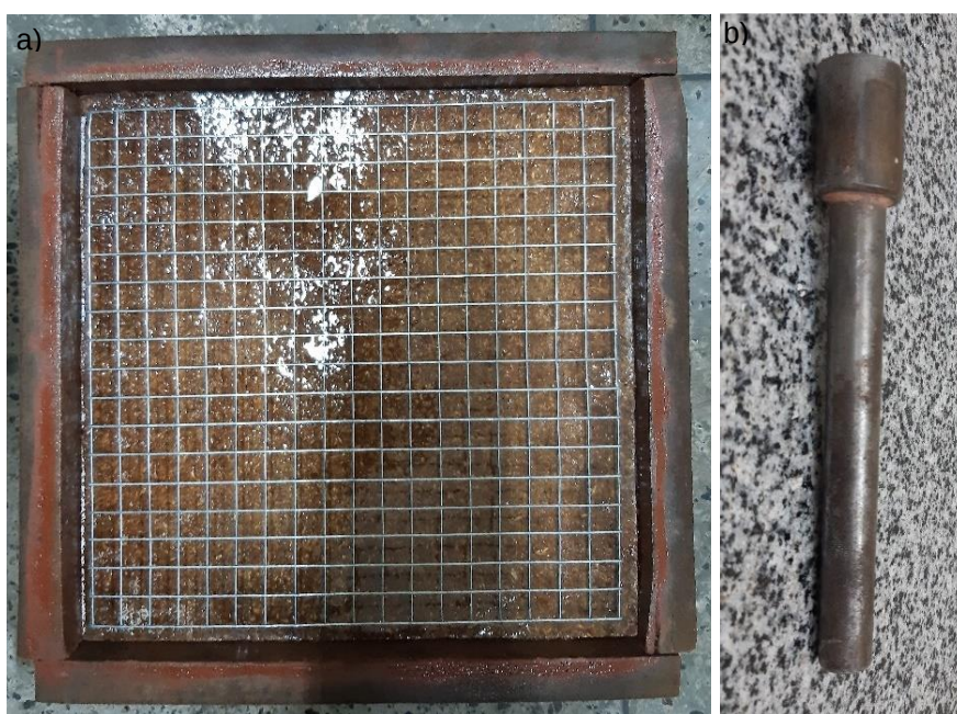
Figura 31: a) Fôrma de madeira com desmoldante e malha metálica; b) Pilão metálico.
