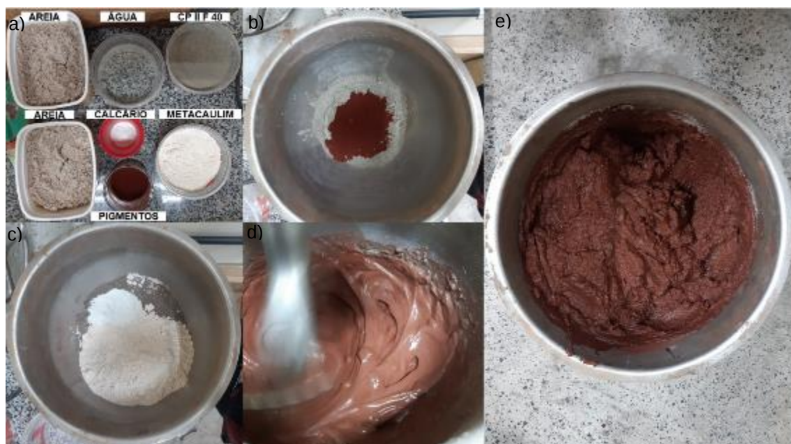
Figura 30: a) Materiais utilizados; b) Mistura do cimento com os pigmentos; c) Adição de metacaulim e calcário; d) Após adição de água; e) Após adição de areia.
