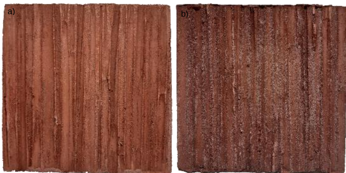
Figura 45: a) LC 3 com pigmentos vermelho e marrom, textura de bambu; b) Cimento CPIIF40 com pigmentos vermelho e marrom, textura de bambu.
