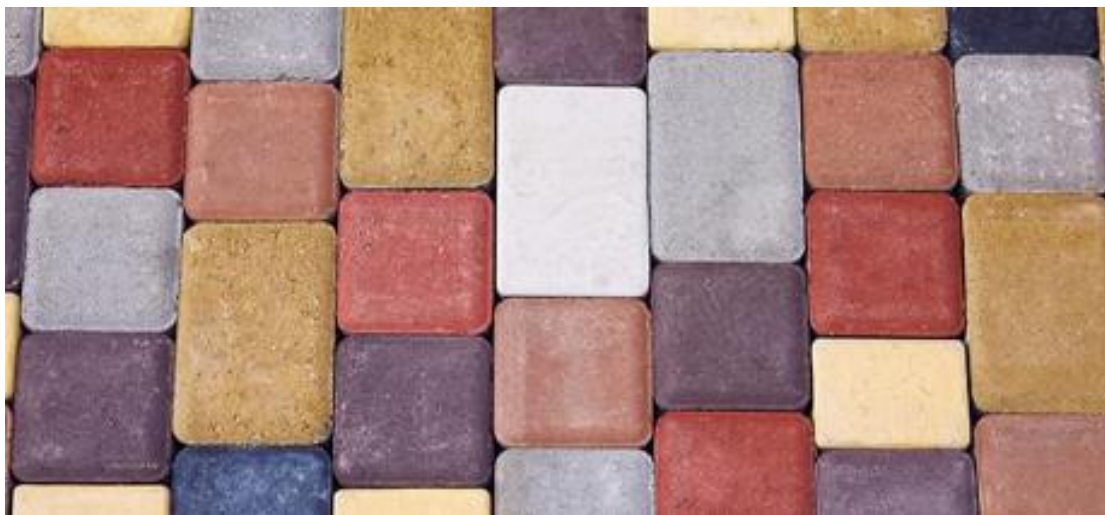
Figura 22: Piso intertravado de concreto colorido.
