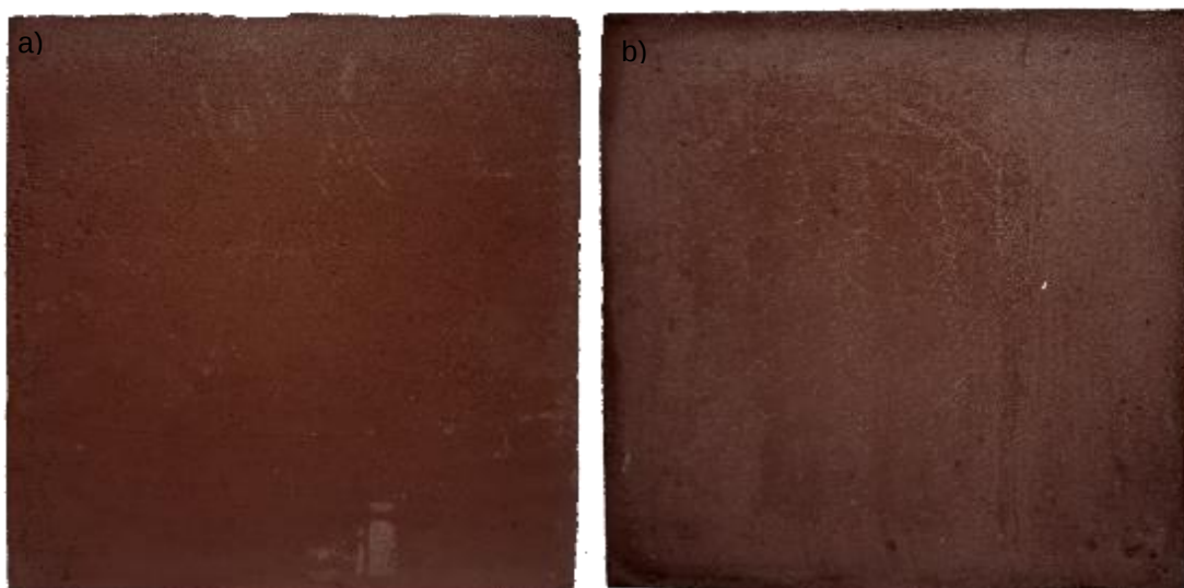
Figura 46: a) LC 3 com pigmentos vermelho e preto, textura lisa; b) Cimento CPIIF40 com pigmentos vermelho e preto, textura lisa.
