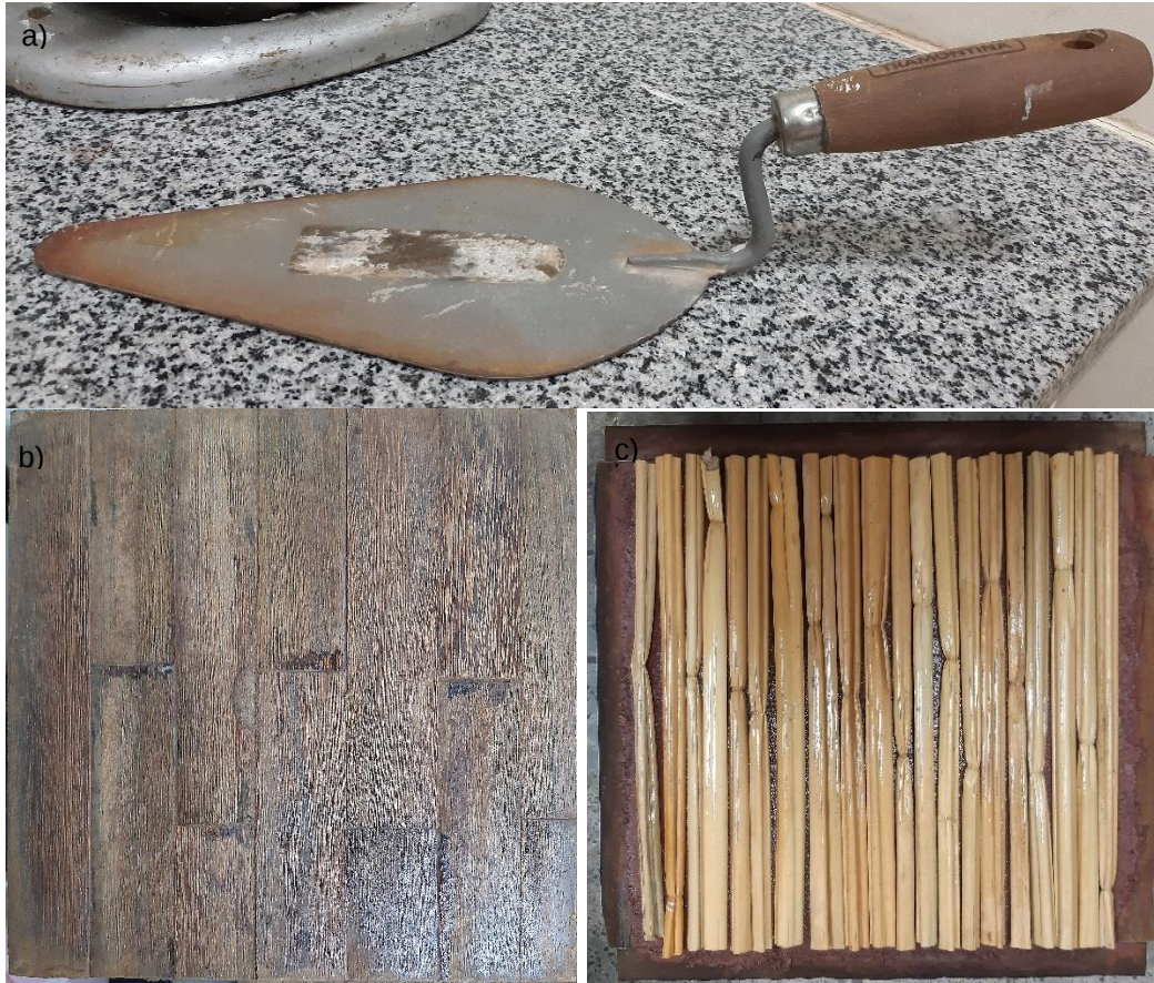
Figura 32: a) Espátula de aço (colher de pedreiro); b) Placa de madeira; c) Posicionamento da palha sobre a argamassa.
