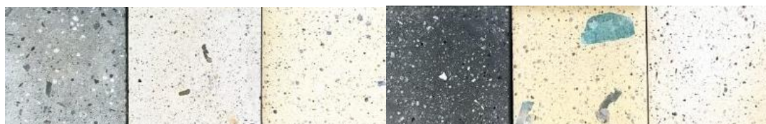
Figura 19: Amostras de concreto com agregado exposto.
