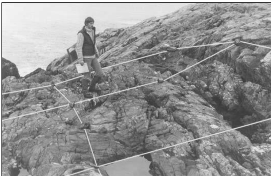
Figura 2 – Grid regular e orientado utilizado para mapeamento de detalhe com o método das quadrículas. Fonte: Lisle et al. (2014).
