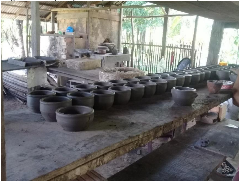
Figura 09 - Peças esperando polimento antes da sinterização.
