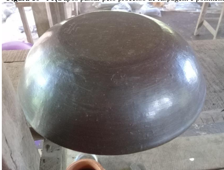
Figura 10 - Peça após passar pelo processo de raspagem e polimento.
