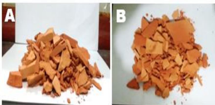
Figura 25 - CP's que não resistiram durante o período de queima e submissão à temperatura de 1000°C no período de 24h.
