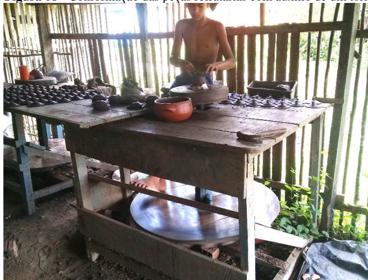
Figura 08 - Conformação das peças refratárias com auxílio de um torno de pedal.
