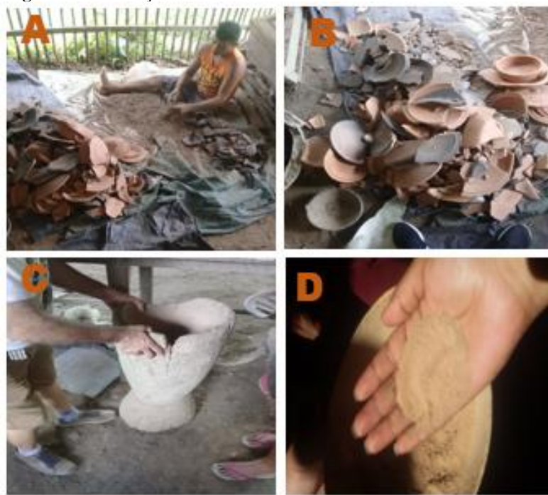
Figura 06 - Produção do chamote na olaria.
