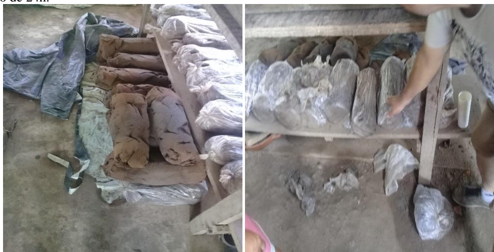
Figura 07 - Mistura (argila + chamote) guardada em sacos plásticos e alocados em prateleiras para descanso de 24h.
