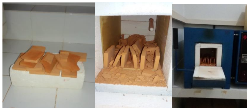
Figura 31 - CP's após o período de queima na mufla.
