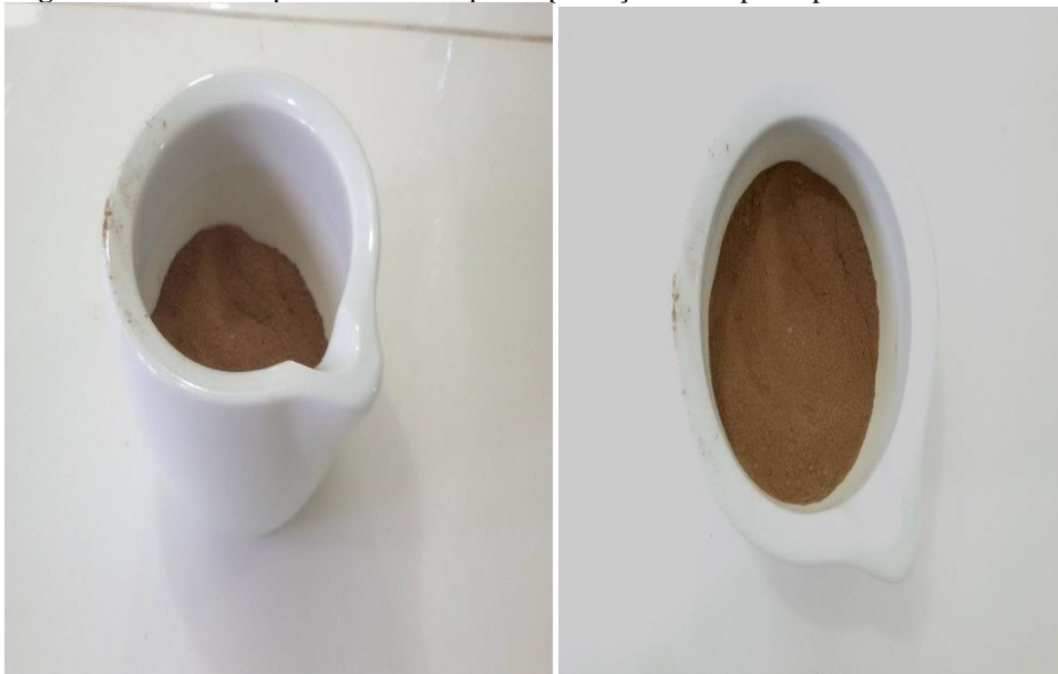
Figura 13 - Chamote peneirado a 80# para a produção do corpo de prova.
