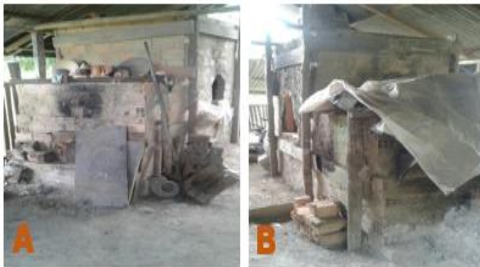
Figura 11 - Vista lateral (A) e (B) do forno utilizado para queimar as peças refratárias.
