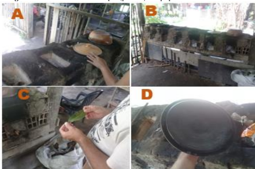
Figura 12 - Processo de defumação (pintura) das peças refratárias.
