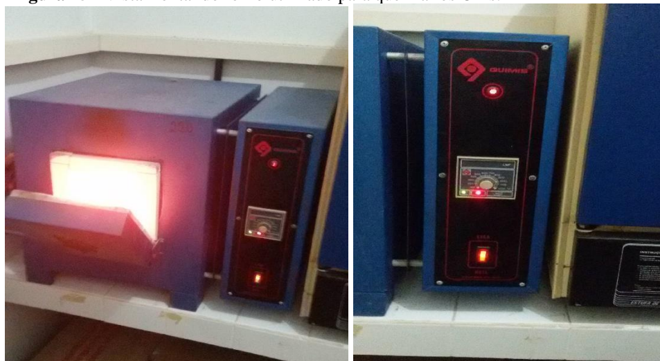
Figura 15 - Vista frontal do forno utilizado para queimar os CP's.
