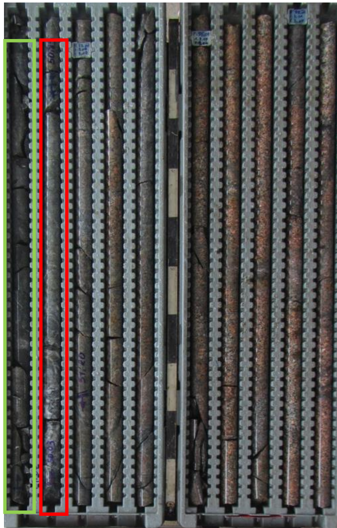
Figura 5 - Exemplo de caixa de testemunho de sondagem da mina São Chico com hidrotermalito (em destaque em verde), veio de quartzo brechado (em destaque em vermelho) e granodiorito com alteração potássica.
