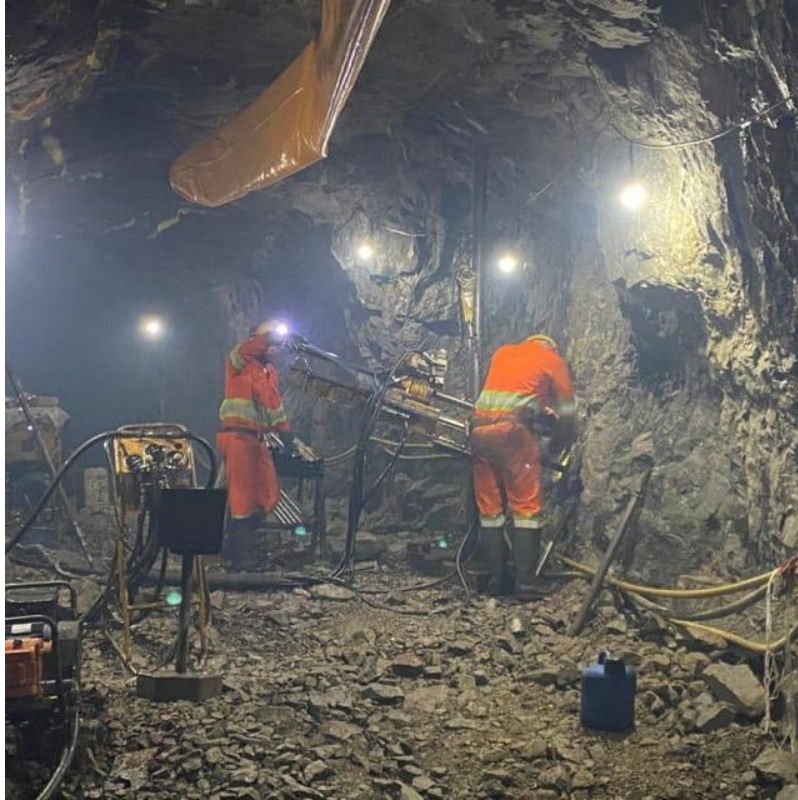
Figura 4 - Praça de sondagem subterrânea na mina São Chico. Sondador e auxiliar de sondagem em atividade de perfuração na mina São Chico.
