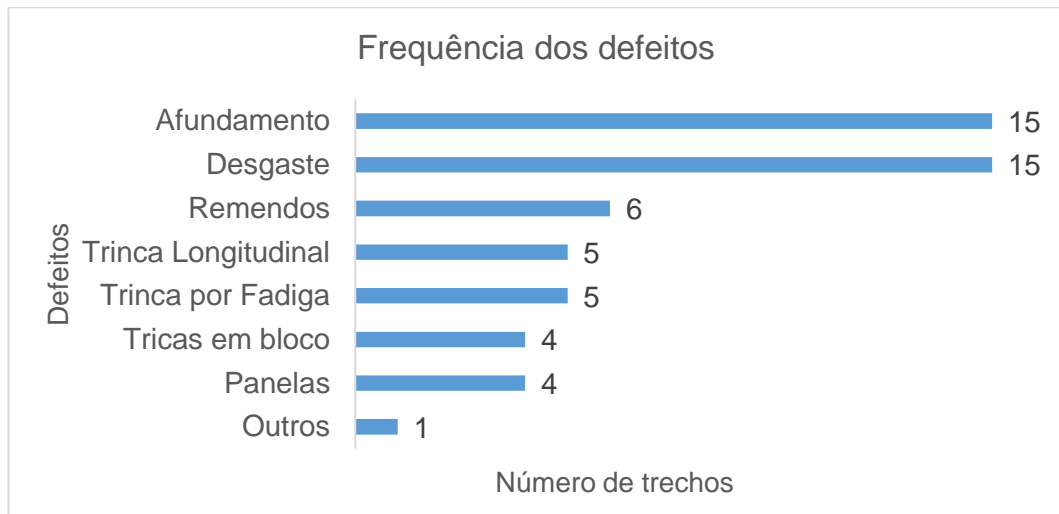
Figura 29 - Gráfico de frequência dos defeitos por trechos
