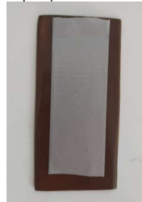
Figura 3 – Posição da fita em relação ao corte em X. Figura 4 – Aplicação da fita no revestimento.
