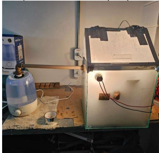
Figura 4 – Realização do ensaio de corrosão por aspensão de névoa salina.
