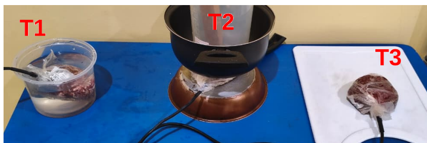
Figura 1: Aparatos experimentais utilizados no estudo. T1: amostra de carne em imersão em água; T2: amostra posicionada entre duas placas de alumínio; T3: amostra exposta ao ar sobre superfície de plástico.
