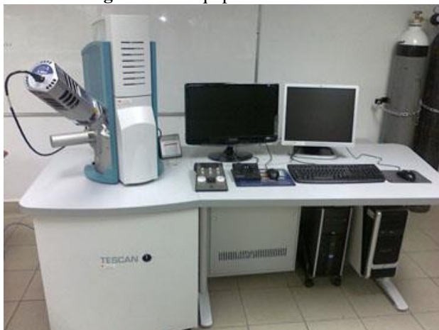
Figura 9: O equipamento de MEV.
