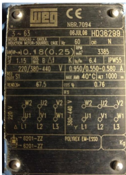
Figura 63 – placa de identificação do Ventilador do Motor CC
