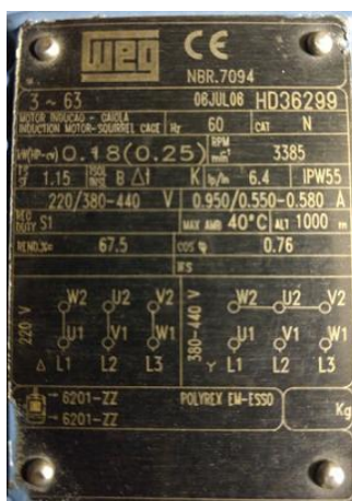
Figura 13 — placa de identificação do motor do sistema de ventilação forçada do Motor CC
