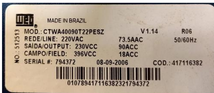
Figura 71 — Etiqueta de identificação do Conversor CA/CC da Bancada Dinâmica
