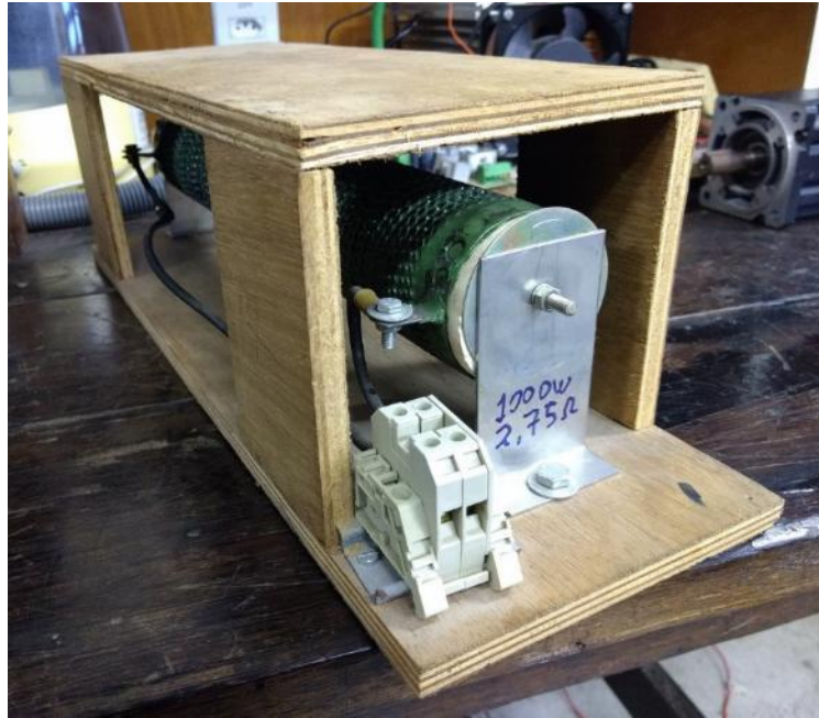
Figura 19 — Exemplar de um dos resistores de potência que compõem a Carga Resistiva Trifásica da Bancada Dinâmica
