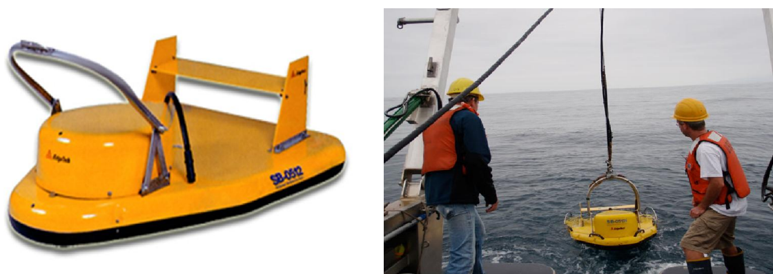
Figura 13 – Modelo tipo chirp , modelo 3200XS, com um townfish modelo 512i, empresa EdgeTech .
