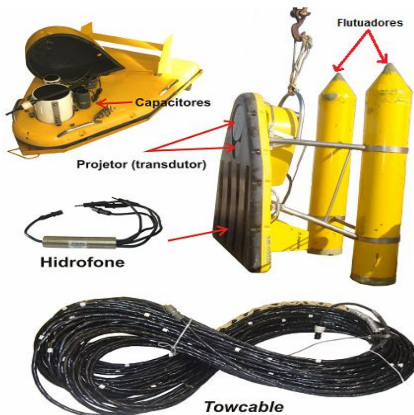
Figura 8 – Fonte acústica do tipo chirp ( townfish ) e seus componentes.
