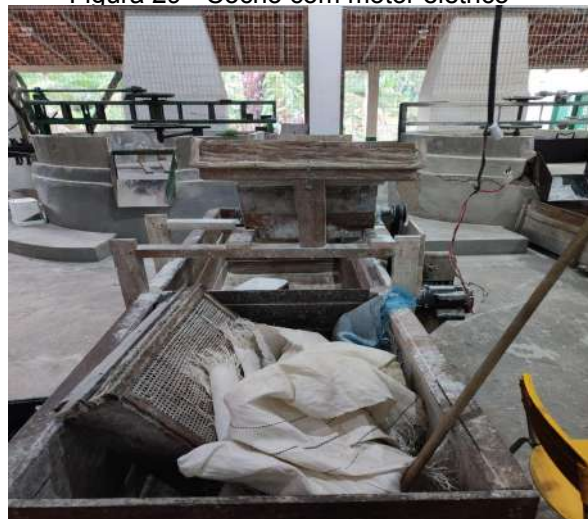
Figura 29 - Cocho com motor elétrico
