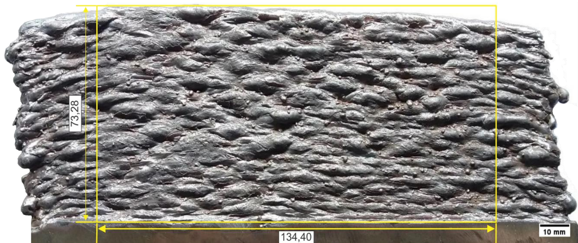
Figura 12 – Parede de solda GMA (medidas em mm).
