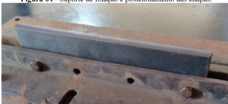
Figura 04 - Suporte de fixação e posicionamento das chapas.
