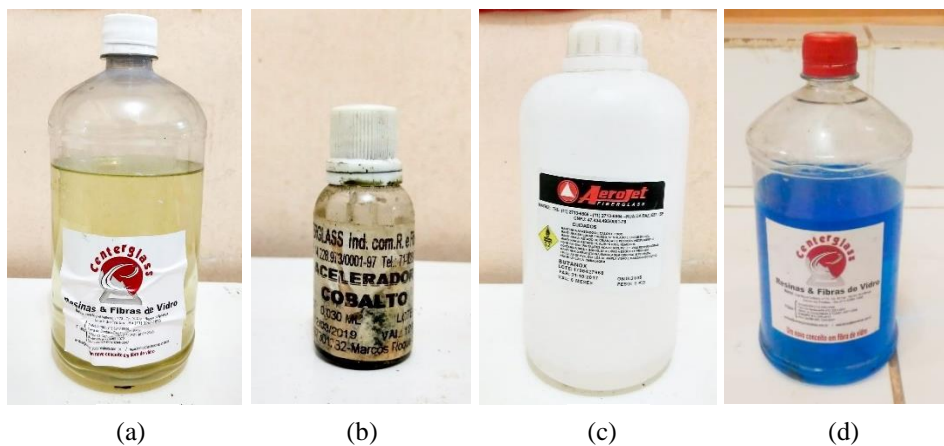
Figura 3.2 – Materiais: (a) resina poliéster insaturada; (b) acelerador de cobalto; (c) iniciador MEK-P e (d) desmoldante.
