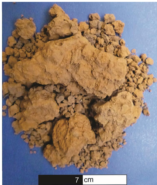
Figura 13 – Exemplo de amostra da cobertura argilosa exibindo o aspecto grumoso e os esferólitos ferruginosos.
