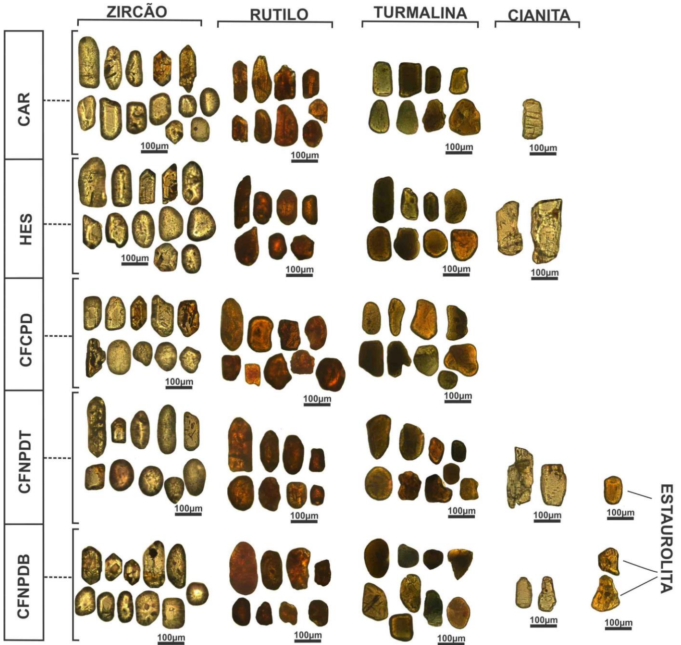
Figura 25 – Fotomicrografias de minerais pesados em luz natural identificados no perfil laterítico imaturo e cobertura argilosa da BR-222, km 137. Crosta Ferroaluminosa Nodular Parcialmente Desmantelada Base (CFNPDB), Crosta Ferroaluminosa Nodular Parcialmente Desmantelada Topo (CFNPDT), Crosta Ferroaluminosa Colunar Parcialmente Desmantelada (CFCPD), Horizonte Esferolítico a Nodular (HES) e Cobertura Argilosa (CAR).
