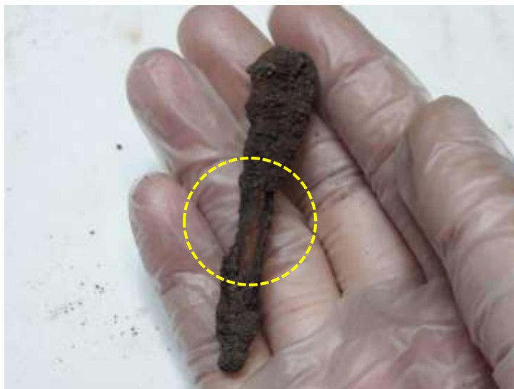
Figura 14: Prego apresentando corrosão e área com destacamento de material.
