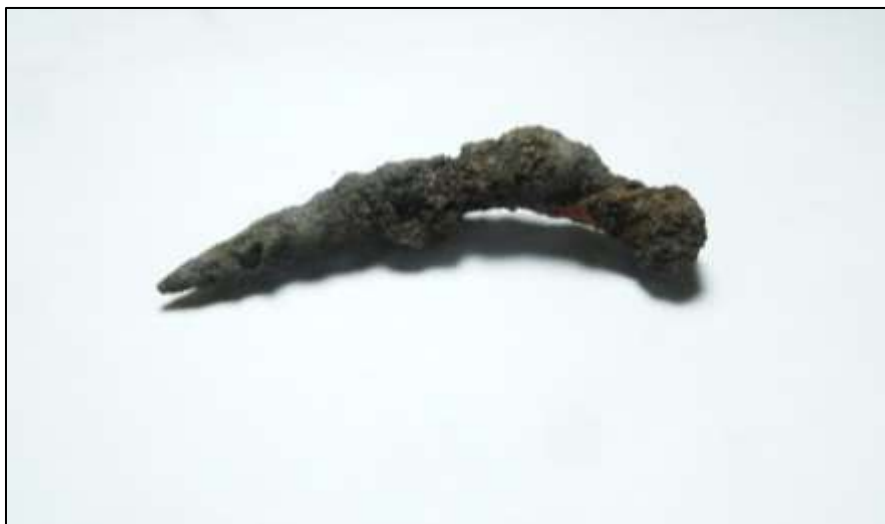
Figura 15: Prego apresentando deformação.
