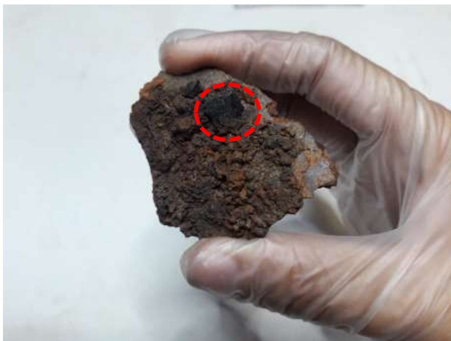
Figura 17: Fragmento metálico apresentando depósito de carvão.
