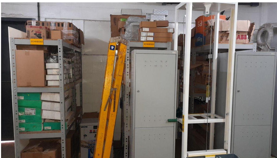
Figura 15 – Corredor entre prateleiras obstruído por equipamentos.
