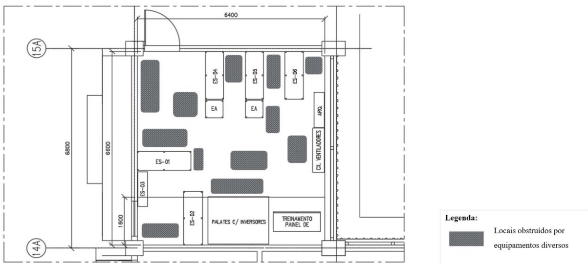
Figura 13 – Locais obstruídos do Centro de Competência de Inversores.
