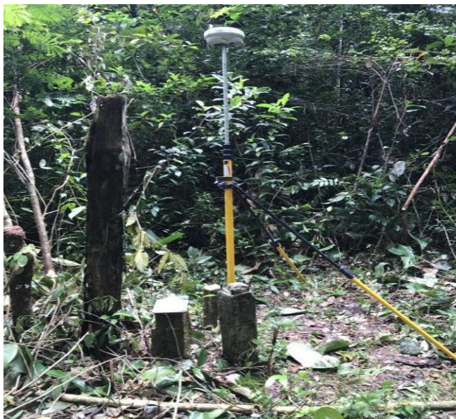
Figura 6 - Localização do marco e instalação do GPS Geodésico
