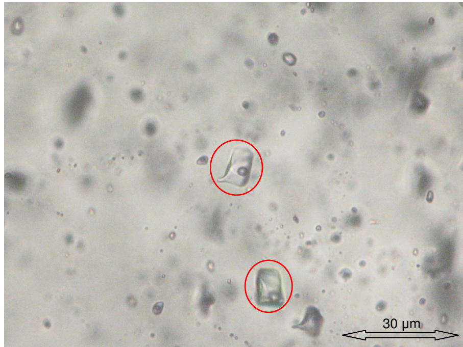
Figura 8: Fotomicrografia de inclusões fluidas bifásicas primárias em forma quadrada dentro dos círculos vermelhos (objetiva 50x).
