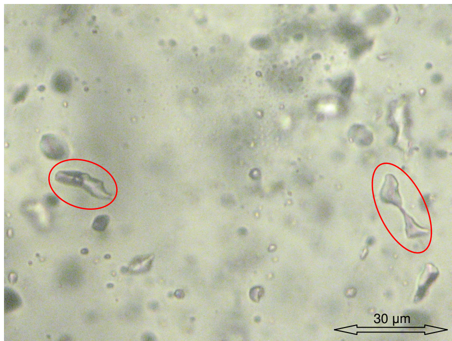
Figura 9: Fotomicrografia de inclusões fluidas bifásicas primárias apresentando sinais de estrangulamento, em elipses vermelhas (objetiva 50x).
