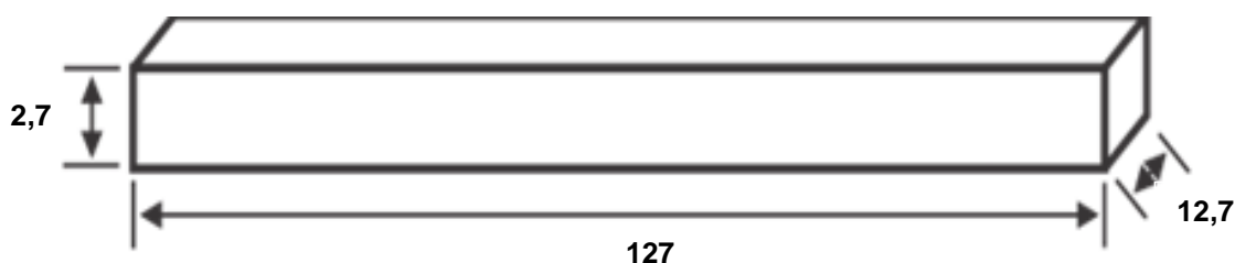
Figura 21 - Ilustração das medidas em milímetros dos corpos de prova para a realização do ensaio de flexão.
