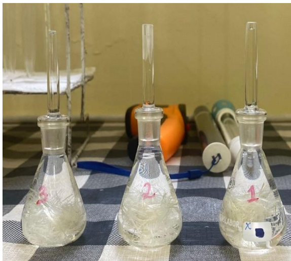
Figura 16 - Picnômetros contendo água e fibra ( m_3 ).
