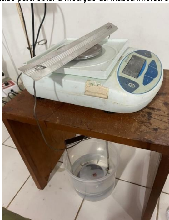
Figura 18 - Aparato utilizado para obter a medição da massa imersa dos corpos de prova.
