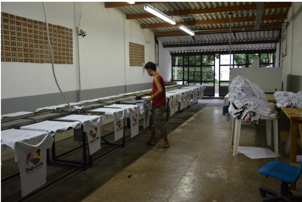
Figura 04: Setor de serigrafia: Processo em que a tela é posta sobre o material (camisas) e a arte é impressa com tinta à base d' água.
