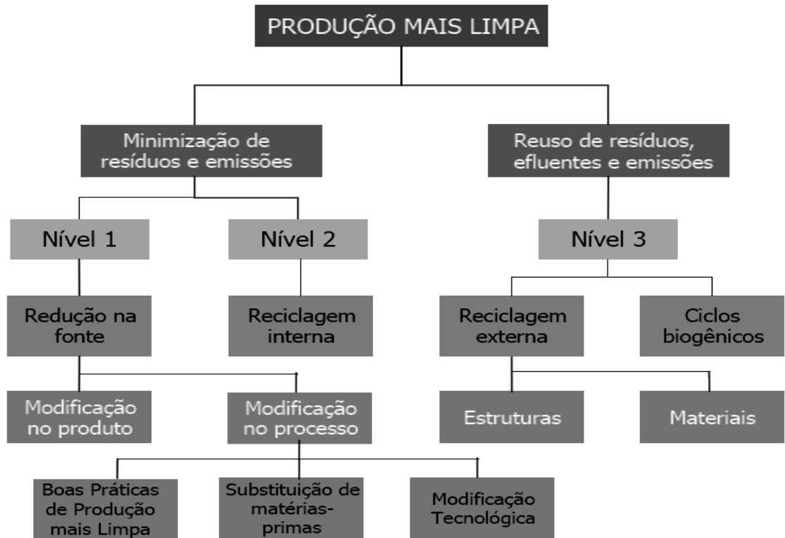
Fig. 07: Fluxograma de Aplicação da PmaisL. Fonte: CNTL (2007, pag. 15).
