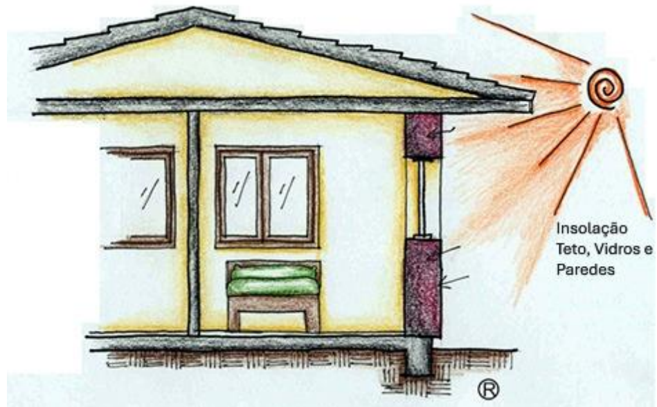
Figura 3. Carga térmica por Insolação.
