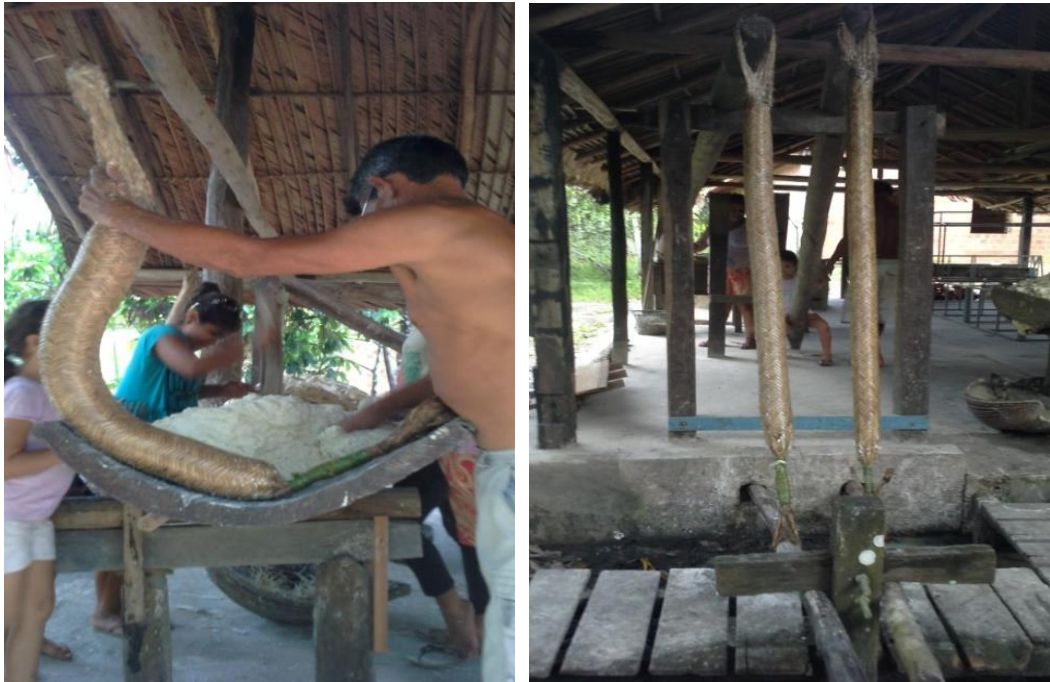
Figura 10: Processo de espremer a massa.
