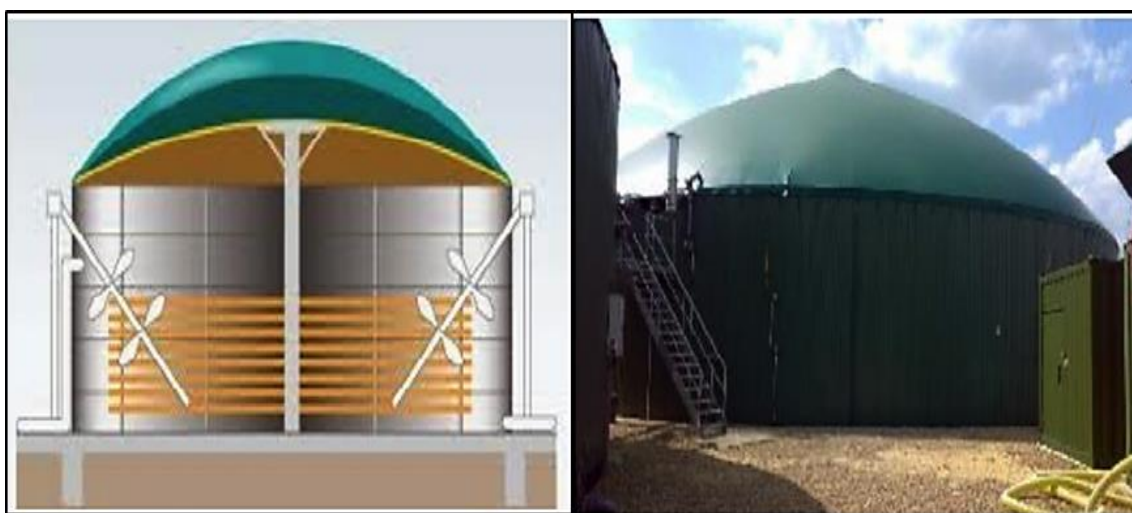
Figura 23. a) CSTR com misturadores tangenciais, b) CSTR. Vista externa.
