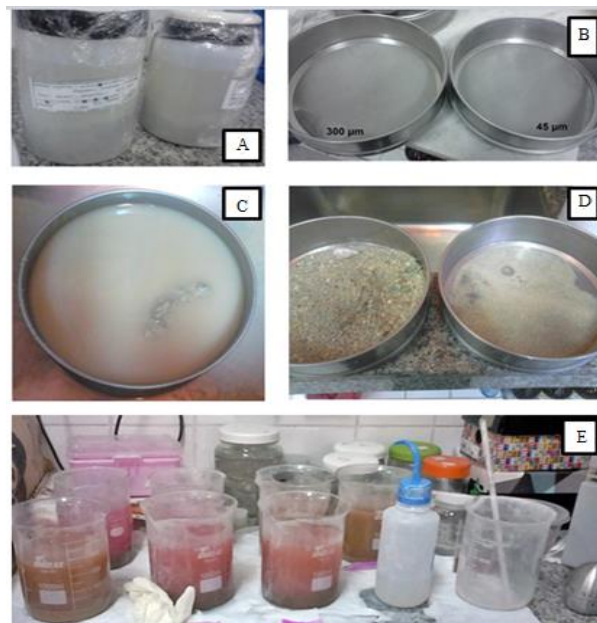
Figura 3: Procedimentos em laboratório; (A) – Frascos com as amostras; (B) – Peneiras de 300 e 45 micrômetros; (C) – Peneira de 300 micrômetros com amostra sedimentológica; (D) – Peneiramento úmido; (E) – Flotação em sílica coloidal (Fonte: Lima, 2016).
