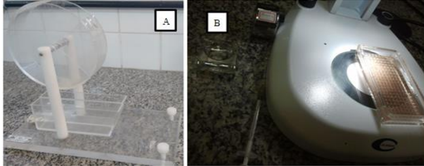
Figura 4: (A) – Quarteador tipo Folsom; (B) – Placa de Dollfus com organismos para visualização em microscópio estereoscópico (Fonte: Lima, 2016).
