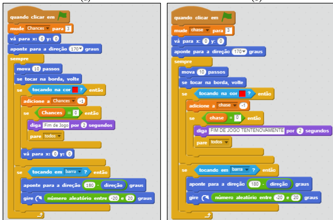
Figura 27 – Programação da bola: forma correta (a) e forma como um aluno realizou (em que não houve o reposicionamento da bola após tocar na área vermelha) (b)
