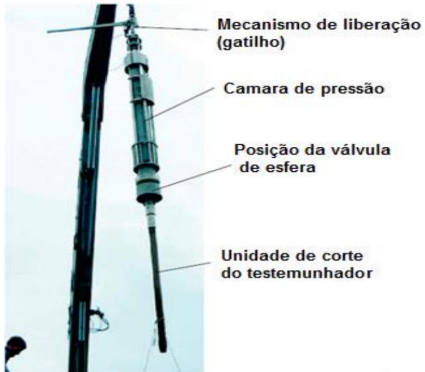
Figura 17- Modelo de testemunhador a pistão para coleta de sedimentos marinhos. Fonte : Steiger (2014)
