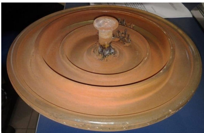
Figura 21 - Isolador do tipo disco de vidro com poluição em sua superfície e com o pino comprometido
