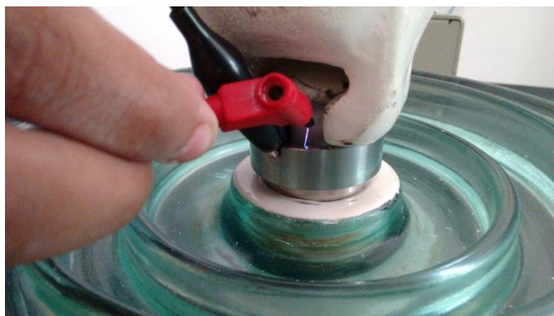
Figura 40 - Blindagem eletrostática após a junção de dois isoladores, entre os quais se encontra o “Dispositivo anticorrosivo”
