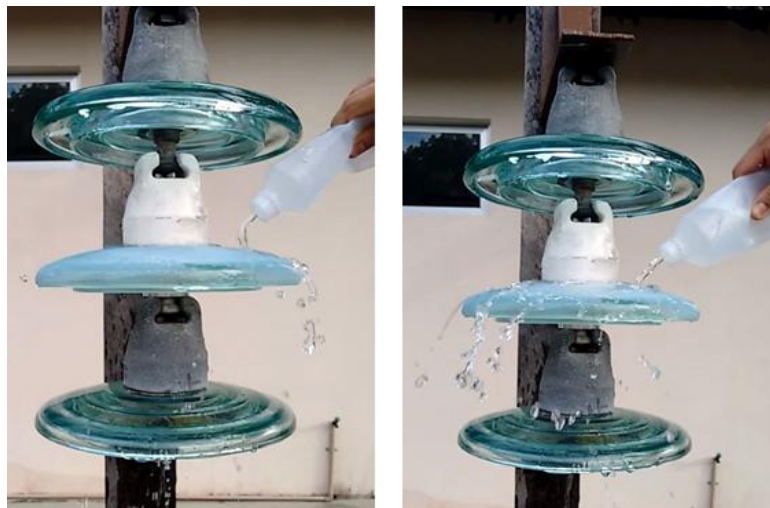
Figura 43 - Simulação de incidência de chuva sobre a superfície dielétrica de um isolador revestido com “NeverWet®”
