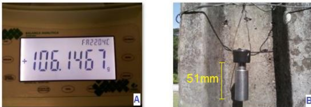
Figura 35 - A) Massa inicial do corpo de prova; B) Pino de aço carbono (corpo de prova) no primeiro dia de exposição
