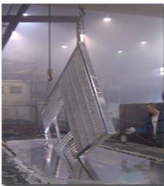
Figura 6 - Galvanização do ferro por mergulho a quente
