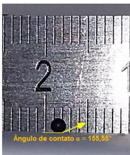
Figura 41 - Ângulo de contato, mensurado com o auxílio do programa ImageJ, entre uma superfície com revestimento super-hidrofóbico e uma pequena gota de água
