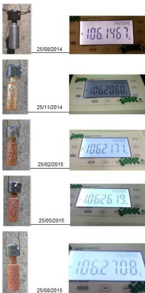
Figura 44 - Variação da massa do corpo de prova
