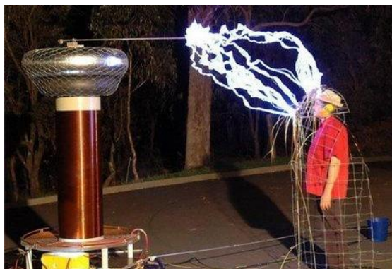
Figura 26 - Gaiola metálica protegendo um homem de uma descarga elétrica
