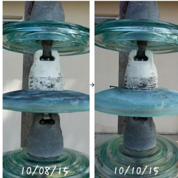
Figura 42 - Princípio de autolimpeza do revestimento super-hidrofóbico
