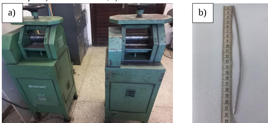
Figura 13 – Laminação: a) Dois laminadores; b) fio de 3 mm.
