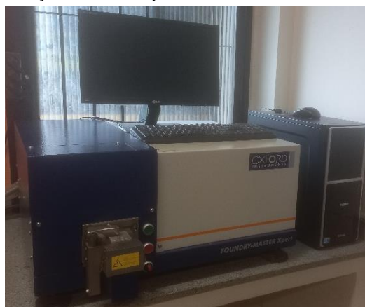
Figura 12 – Espectrômetro para a realização da análise química.
