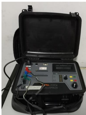
Figura 15 – Dispositivo de medição de resistividade elétrica.
