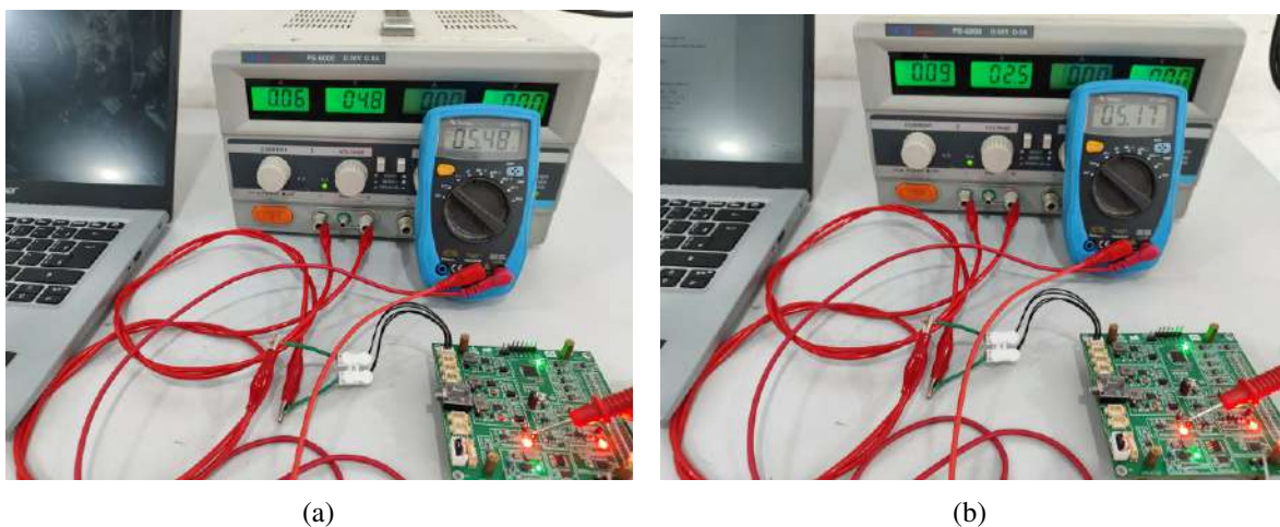
Figura 68 – Aferição de tensão na saída do sistema MPPT para: (a) entrada 4,8 V, (b) entrada 2,5 V
