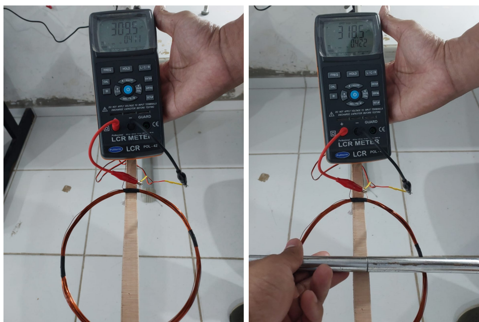
Figura 34 – Bobina de 28 voltas, medição de indutância: (a) Ausência de metais; (b) Presença de metais.
