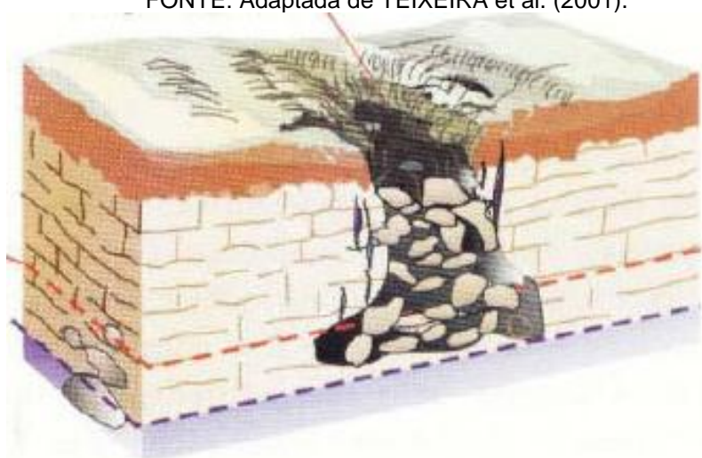
Figura 10 - Dolina de colapso. FONTE: Adaptada de TEIXEIRA et al. (2001).
