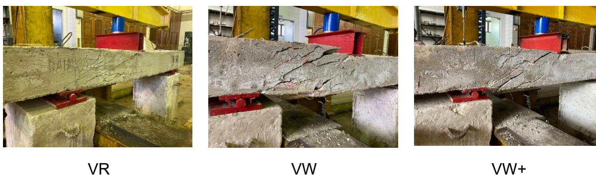
Figura 24 – Quadros de fissuração das vigas VR, VW e VW+.
