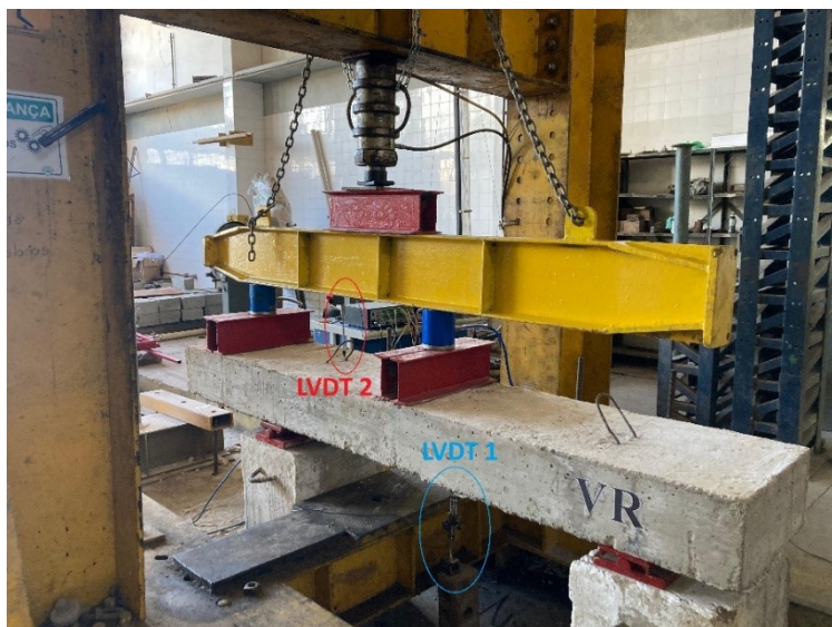
Figura 23 – Sistema de medição dos deslocamentos verticais
